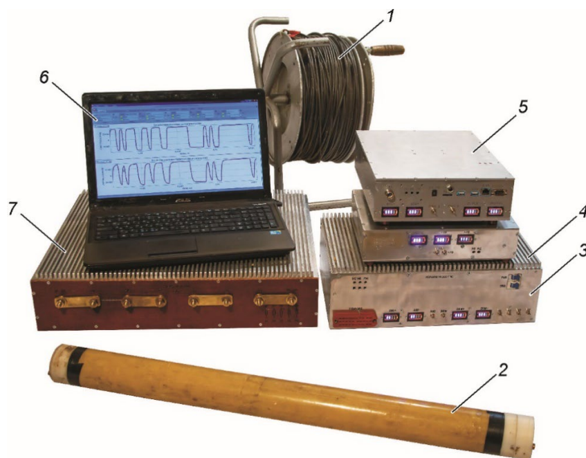
Рисунок 5.1 - Экспериментальный образец измерительного комплекса ЭРК ШПС, внешний вид: 1 – индукционная зондирующая рамка (ИЗР); 2 – индукционный датчик сигналов (ИДС); 3 – генератор зондирующих сигналов (ГЗС); 4 – устройство градуировки (УГ); 5 – блок управления и регистрации сигналов (БУРС); 6 – переносной компьютер (ПК); 7 – блок ограничения тока (БОТ) (выполнено автором)
