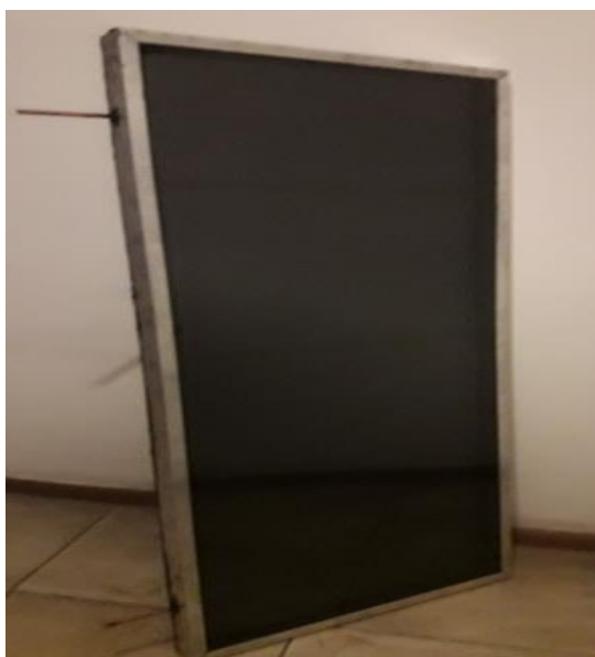
Рисунок 3.2 - Натурная модель плоского солнечного гелиоколлектора
