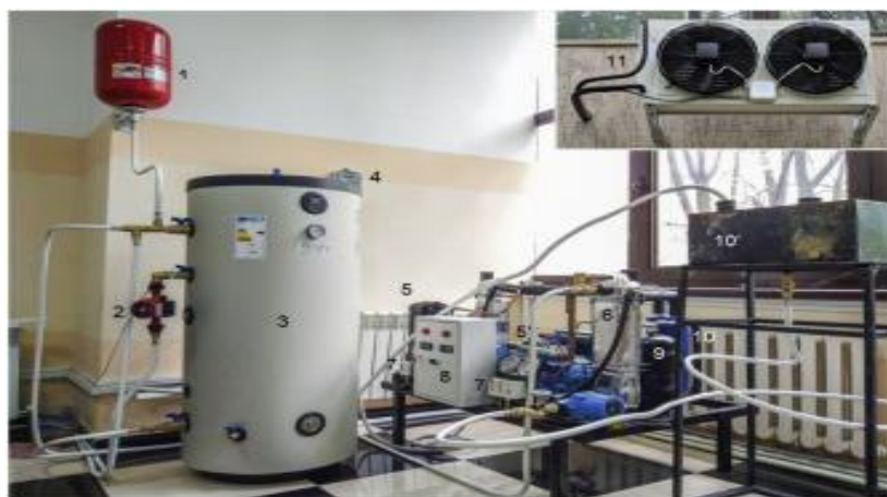
Рисунок 1.9 - Прототип двухконтурной гелиосистемы теплового насоса с внешним источником
