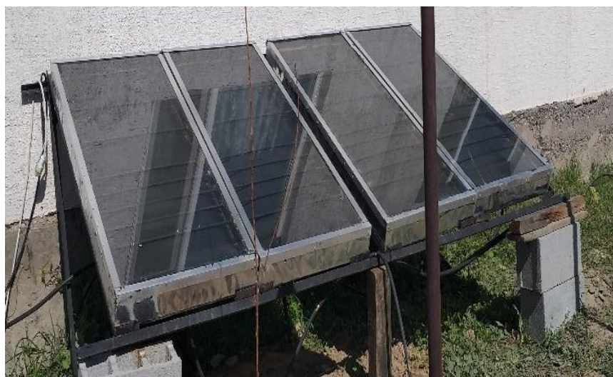
Рисунок 1.28 - Натурная модель плоского солнечного гелиоколлектора
