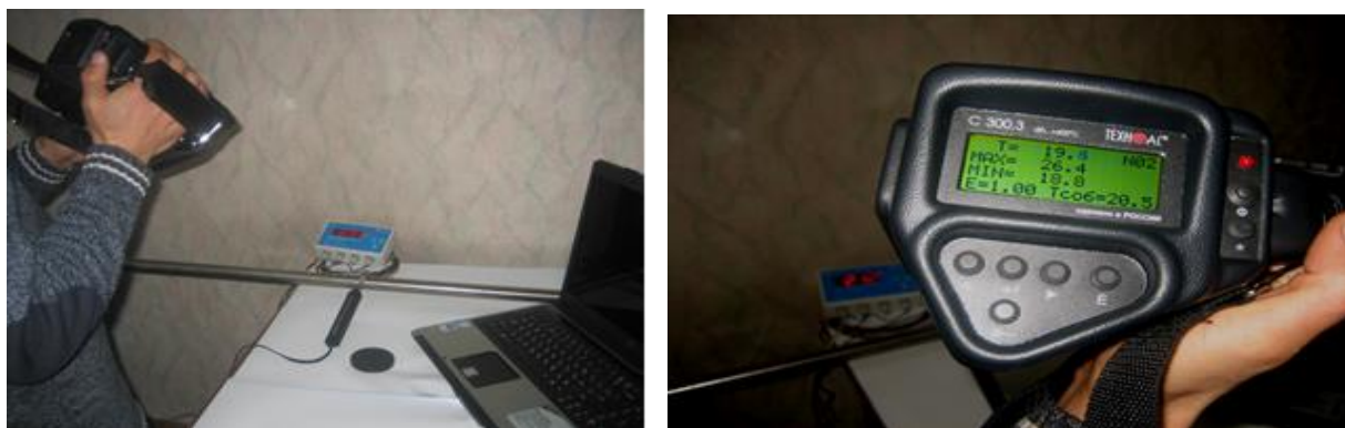
Рисунок 3.1 - Проверка датчиков температур с помощью пирометра инфракрасного С 300-3 «Фотон»
