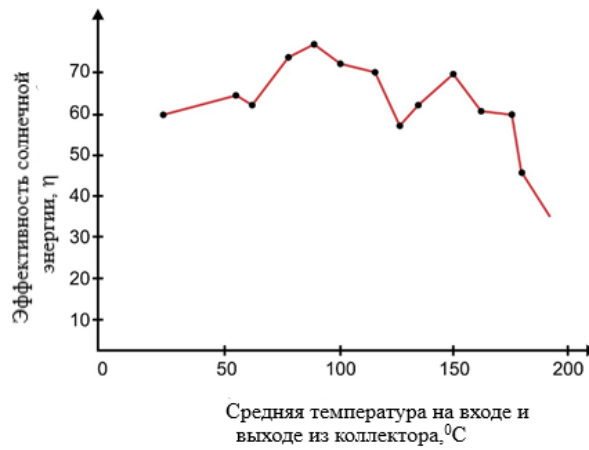
Рисунок 3.7 - Зависимость эффективности гелиоустановки от средней температуры на входе и выходе из коллектора.
