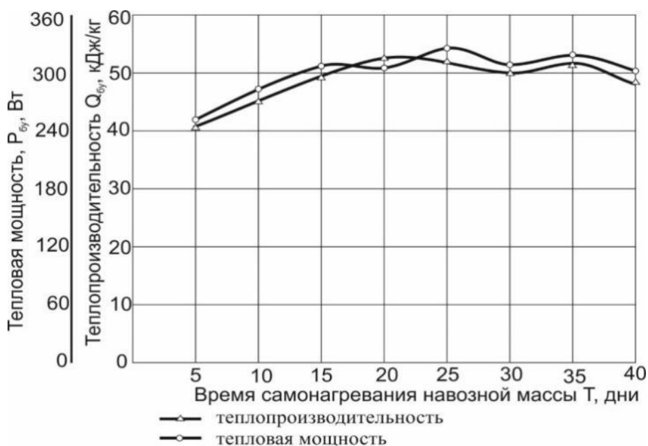
11 – сүрөт-биотермикалык орнотмонун жылуулук кубаттуулугунун кык массасынын өзүн-өзү жылытуу убактысына көз карандылыгы
