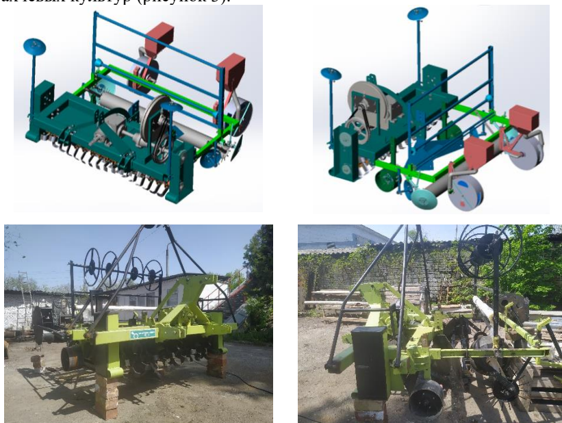
Рисунок 3 – Конструктивный чертеж и фото разработанной сеялки для посева бахчевых культур
