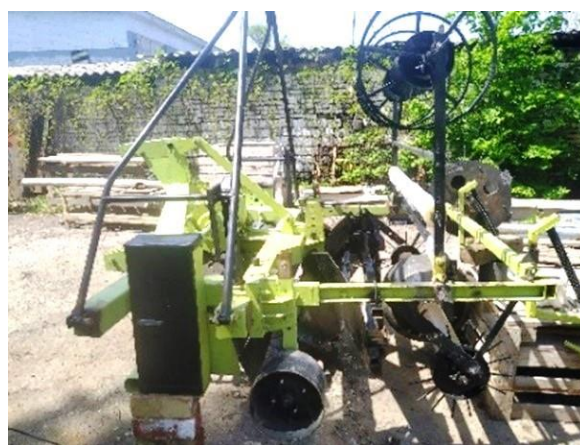
Рисунок 3 – Конструкторский чертёж и фото разработанной сеялки для посева бахчевых культур
