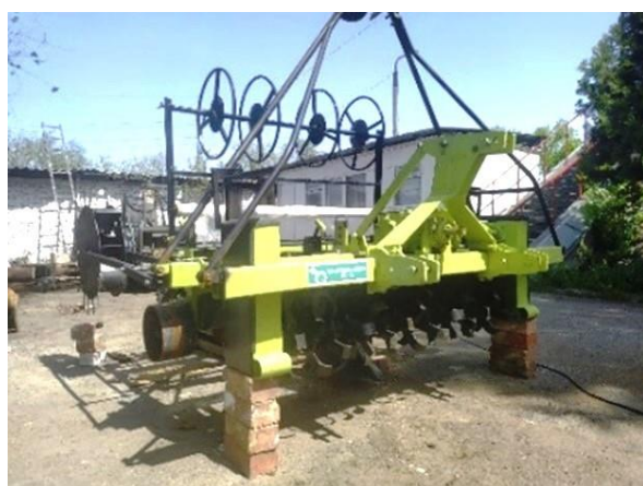
Рисунок 3 – Конструкторский чертёж и фото разработанной сеялки для посева бахчевых культур
