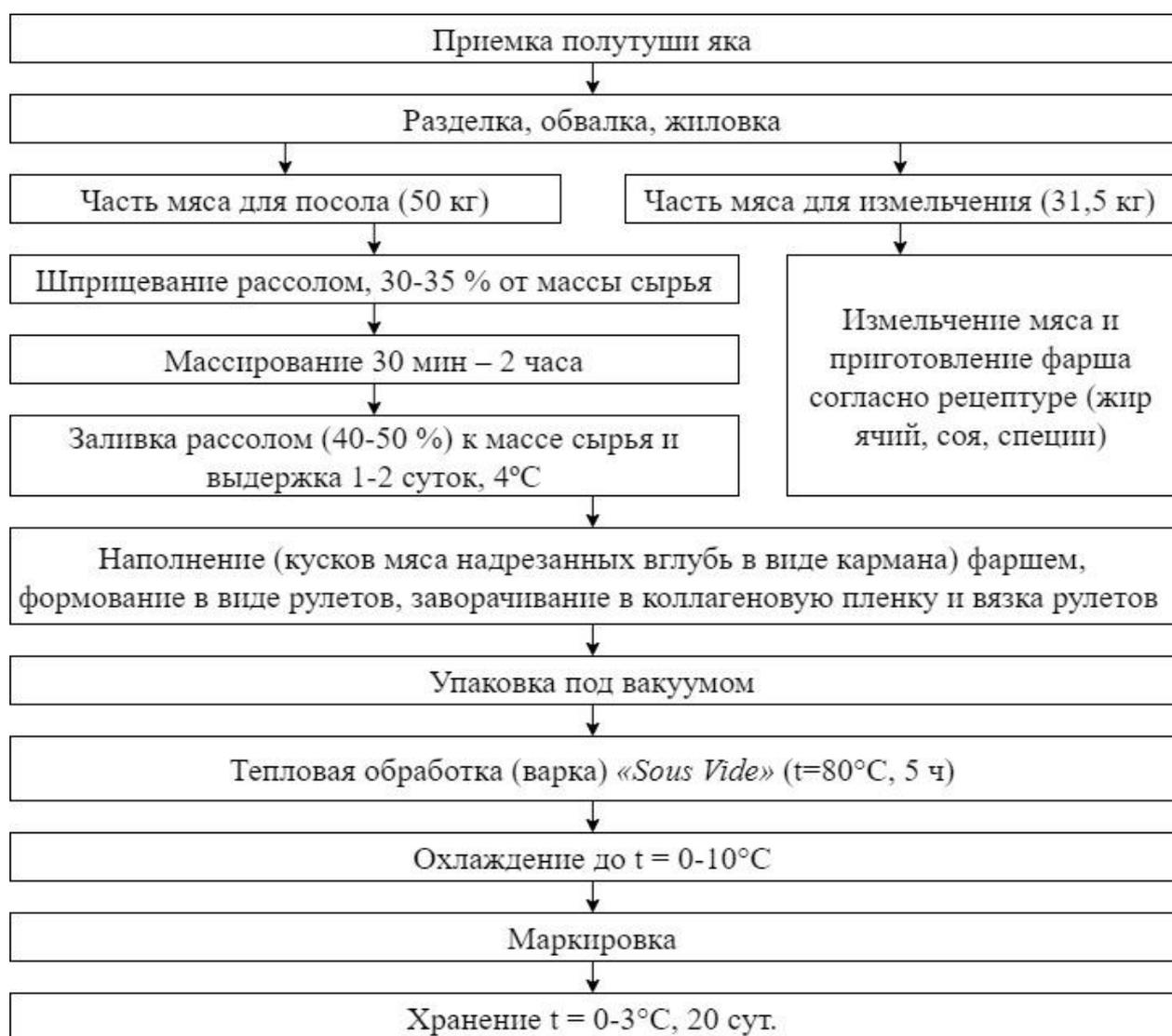
Рисунок 4.7 – Технологическая схема изготовления фаршированного рулета с применением «*Sous Vide*» тепловой обработки
