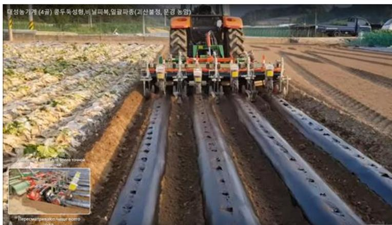
Рисунок 1.12 - Корейская технология, укладки мульчирующей пленки
