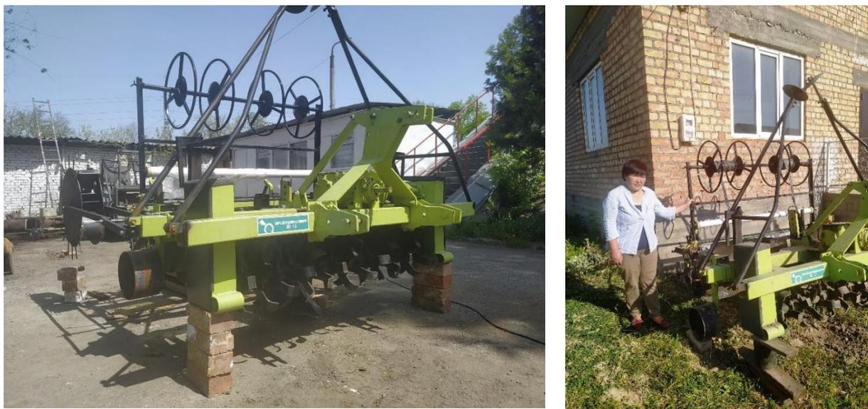
Рисунок 2.18 – Фото разработанной сеялки для посева бахчевых культур
