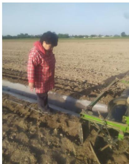
Рисунок 4.9 - Полевые испытания сеялки для бахчевых культур
