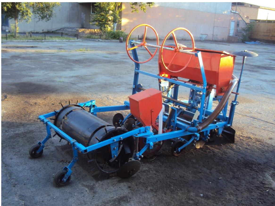
Рисунок 1.24 – Китайская сеялка для капельного орошения с механизмом укладки капельных лент
