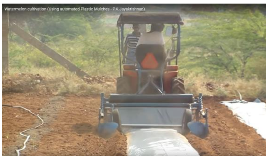
Рисунок 1.11 – Технология посева, с укладкой мульчирующей пленки на поле, перед посевом бахчевых культур
