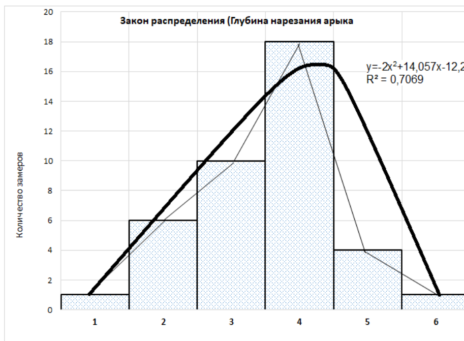
Рисунок 4.12 – Гистограмма распределения глубины нарезания арыков: R^2 – величина достоверности аппроксимации
