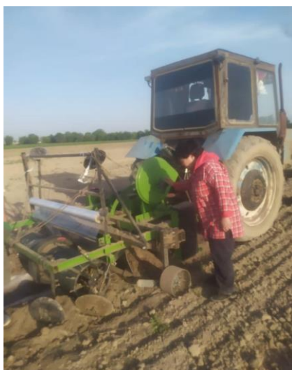
Рисунок 4.9 - Полевые испытания сеялки для бахчевых культур
