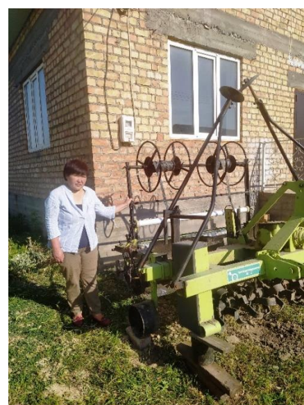
Рисунок 2.15 – Чертеж и фото разработанной сеялки для посева бахчевых культур
