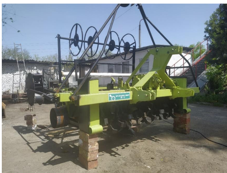
Рисунок 2.15 – Чертеж и фото разработанной сеялки для посева бахчевых культур
