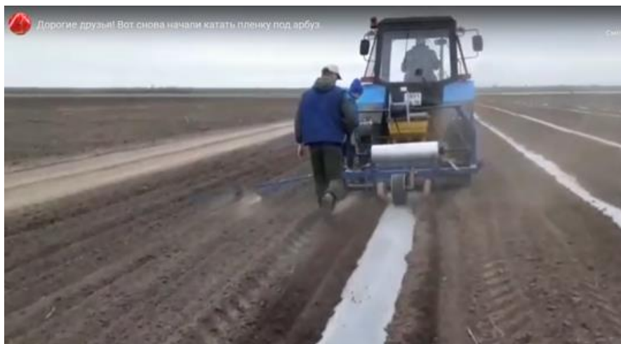
Рисунок 1.14 – Российская технология укладки полиэтиленовой пленки
