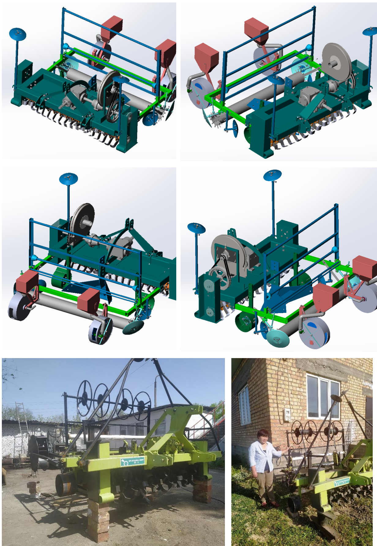
Рисунок 2.15 – Чертеж и фото разработанной сеялки для посева бахчевых культур
