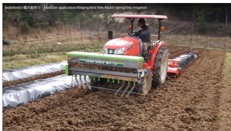
Рисунок 1.13 - Японская технология укладки мульчирующей пленки с одновременным внесением минеральных удобрений
