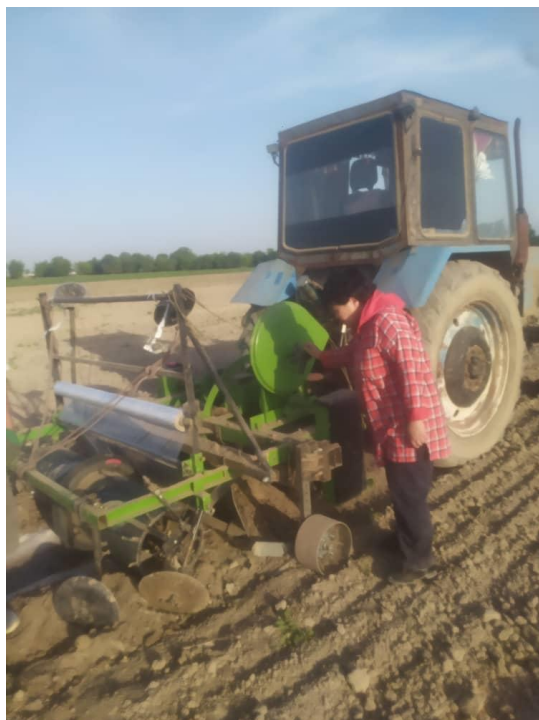
Рисунок 4.1 -Полевые испытания сеялки для бахчевых культур
