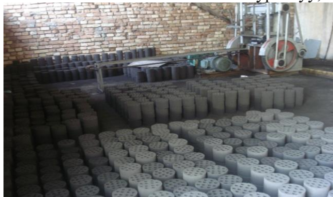
9-сүрөт – Аралашманы атайын прессте ныктоо, тешиктери бар брикеттерди алуу
