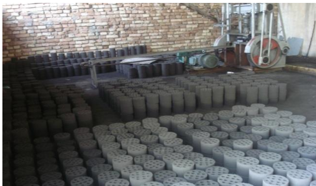
Рисунок 9 – Уплотнение смеси на специальном прессе в пресс-форме, брикеты со сквозными дырками.
