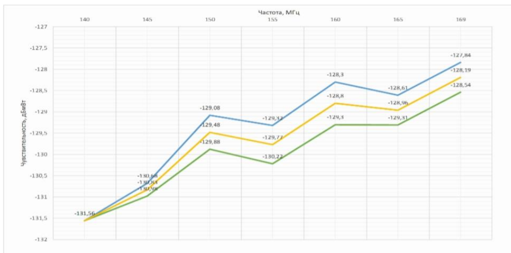
Рисунок 3.1 - Чувствительность радиоприёмного тракта РЛС П-18М
