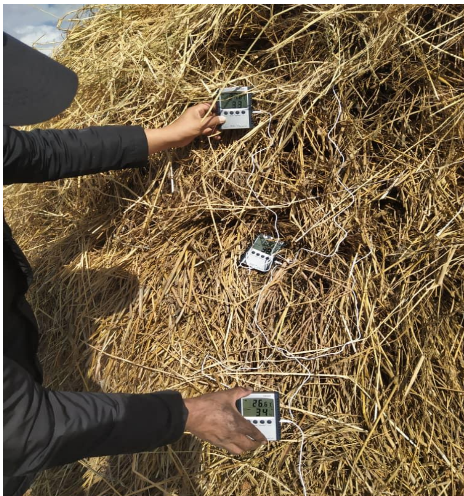
Рис.2.1. Прибор для автоматического измерения температуры и влажности внутри скирды снопов зерновки шалы риса HC 520 DIGITAL
