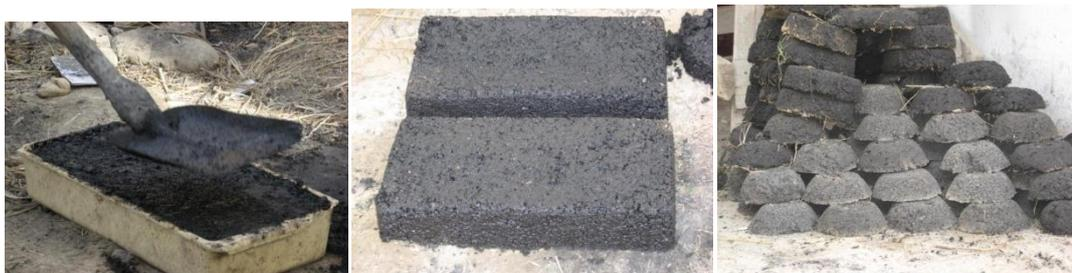
Рисунок 4.1 - Послойная набивка смеси в съемную форму – опалубку, естественная сушка брикетов, складирование.
