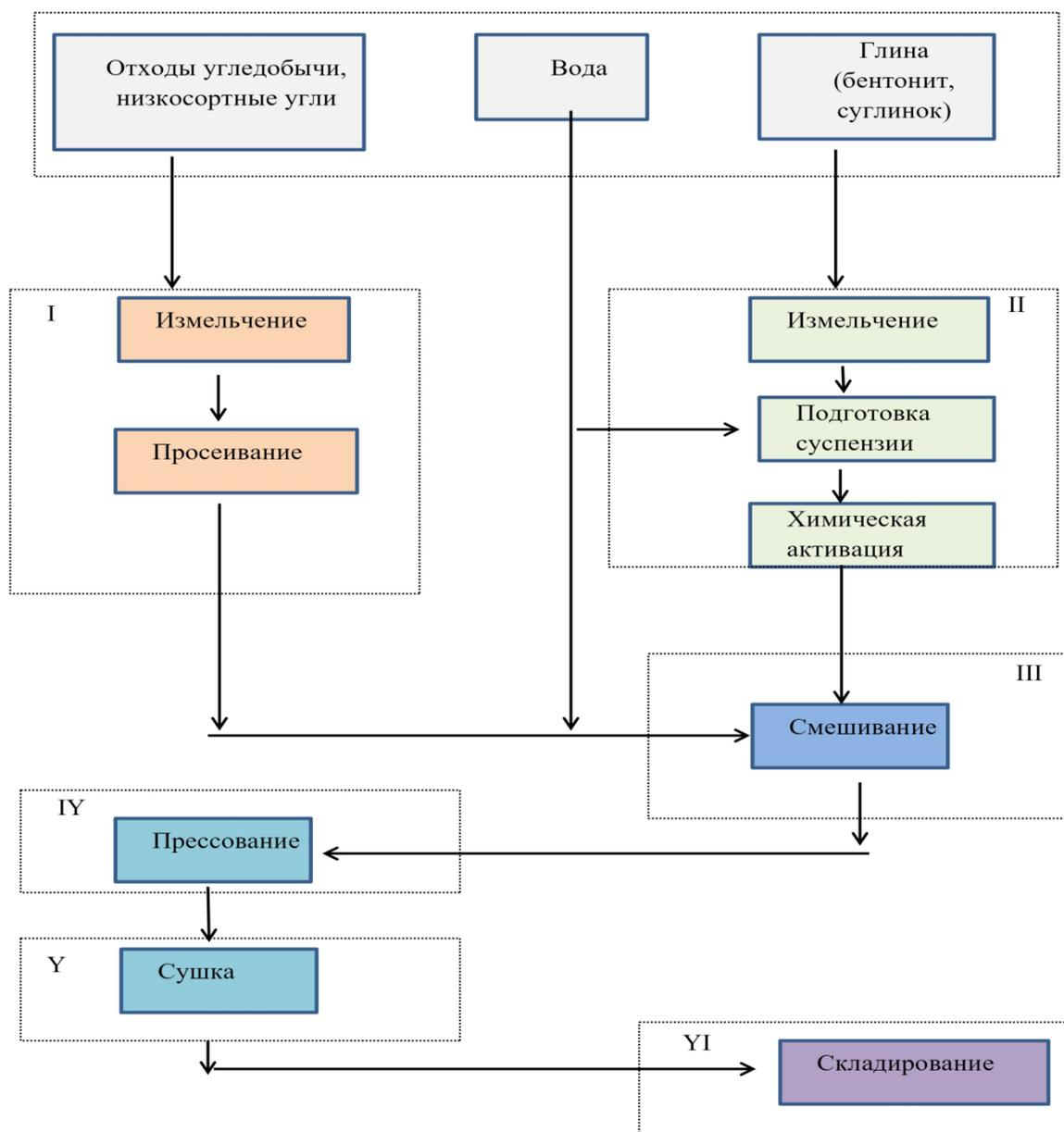
Рис.4.3 - Блок схема промышленной технологии брикетирования угольной мелочи с неорганическими связующими
