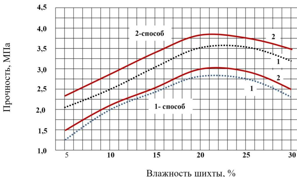
Рис. 2.11 - Зависимость прочности ОМБТ Р от исходной влажности W и способа подготовки шихты: 1 – жатанский уголь, 2 – кожокеленский уголь
