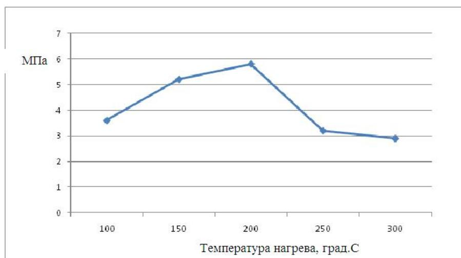
Рисунок 3.17- Зависимость прочности брикета от температуры нагрева битума.
