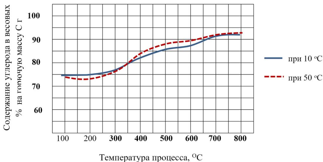
Рисунок 2.2 - Содержание углерода в твердых остатках полученных при различных скоростях нагрева Жатанского угля в весовых процентах
