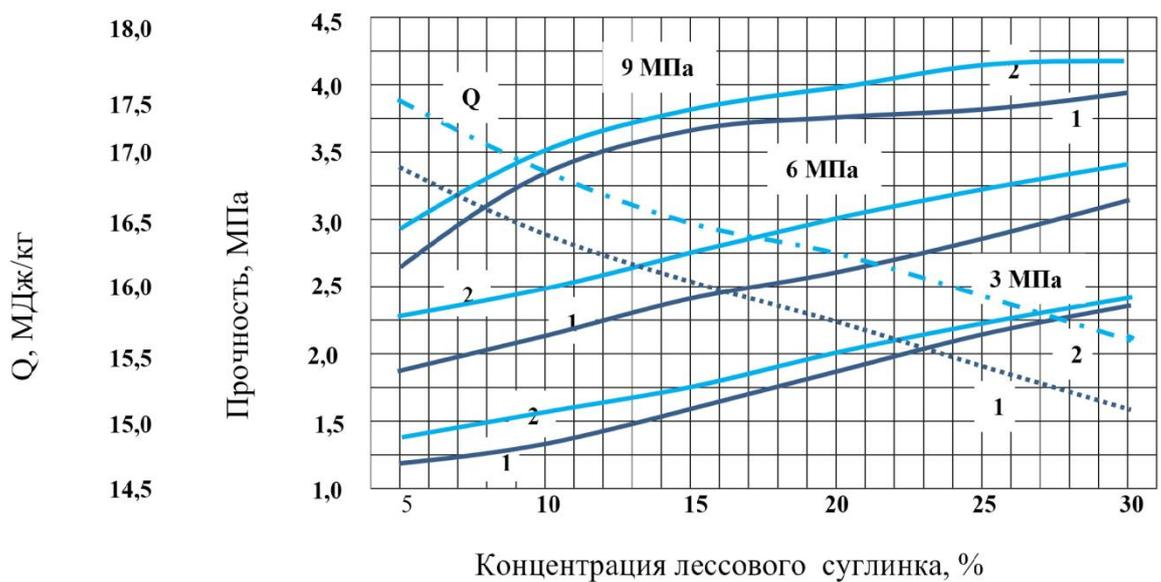
Рис.3.14 - Зависимость прочности Р и теплотворности Q - КТТ от концентрации С лессового суглинка в шихте при различных давлениях прессования: 1 – жатанский уголь, 2 – кожокеленский уголь
