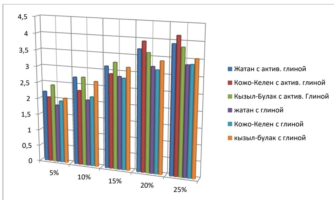
Рис. 3.9 - Зависимость прочности  $P$  КТТ от концентрации активированной бентонитовой глины, а также без активации в шихте.
