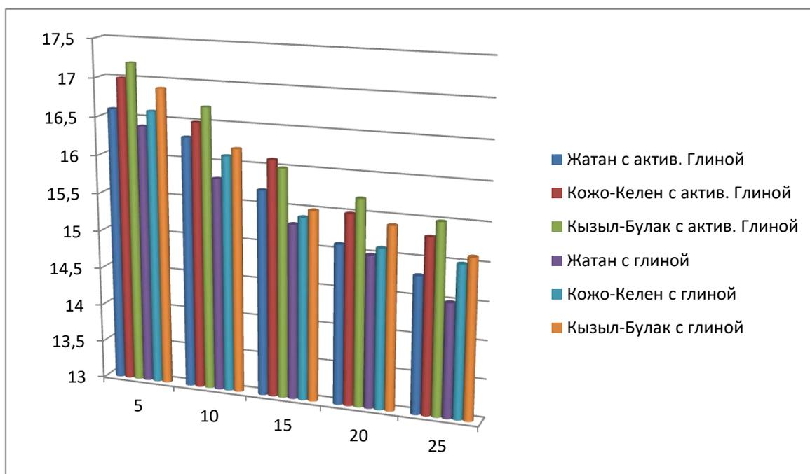
Рис. 3.10 - Зависимость теплотворности  $Q$  КТТ от концентрации активированного бентонита, а также неактивированного бентонита.
