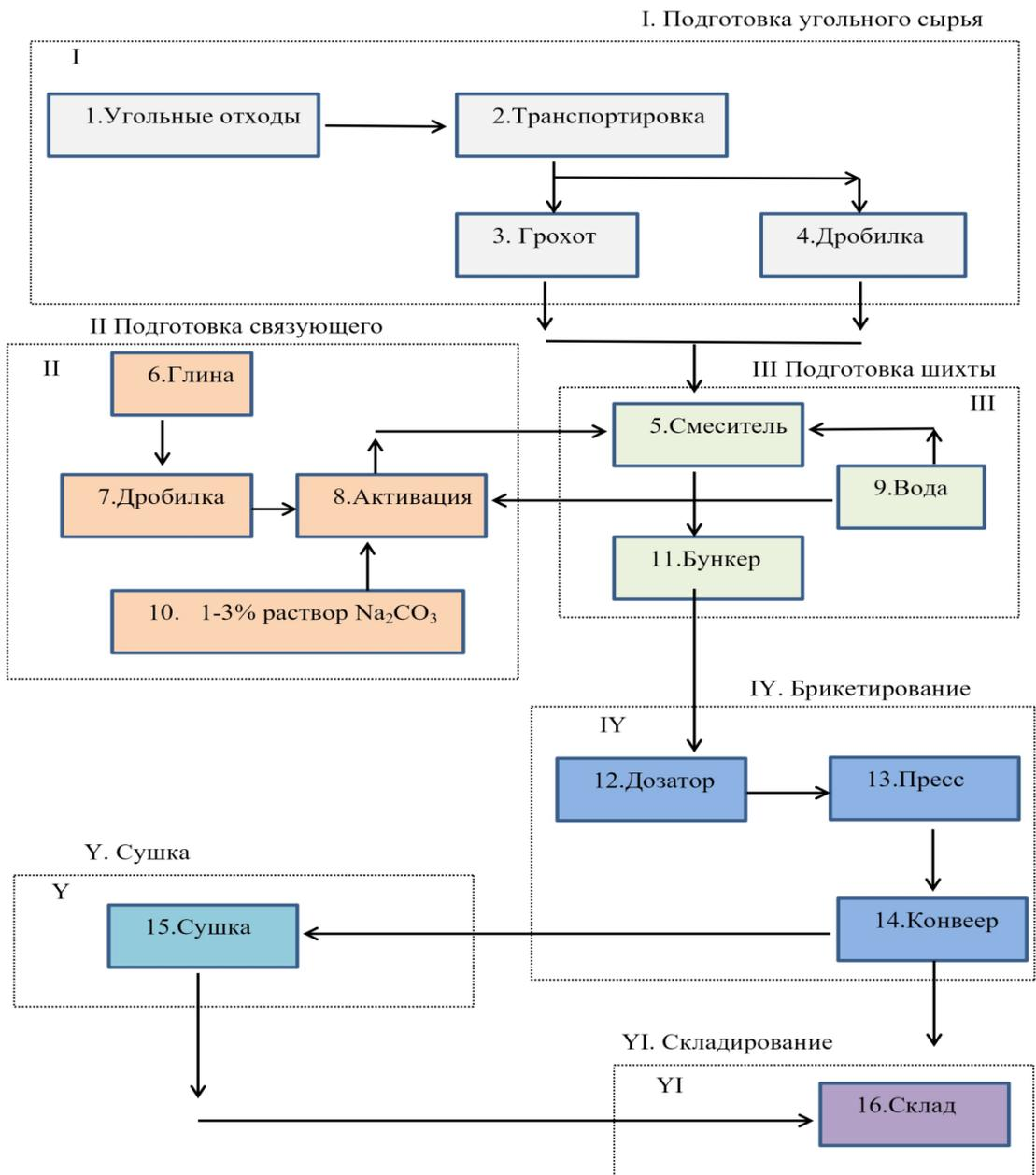
Рис.4.4 - Технологическая схема промышленной технологии брикетирования углей с бентонитовой глиной и лессовым суглинком.
