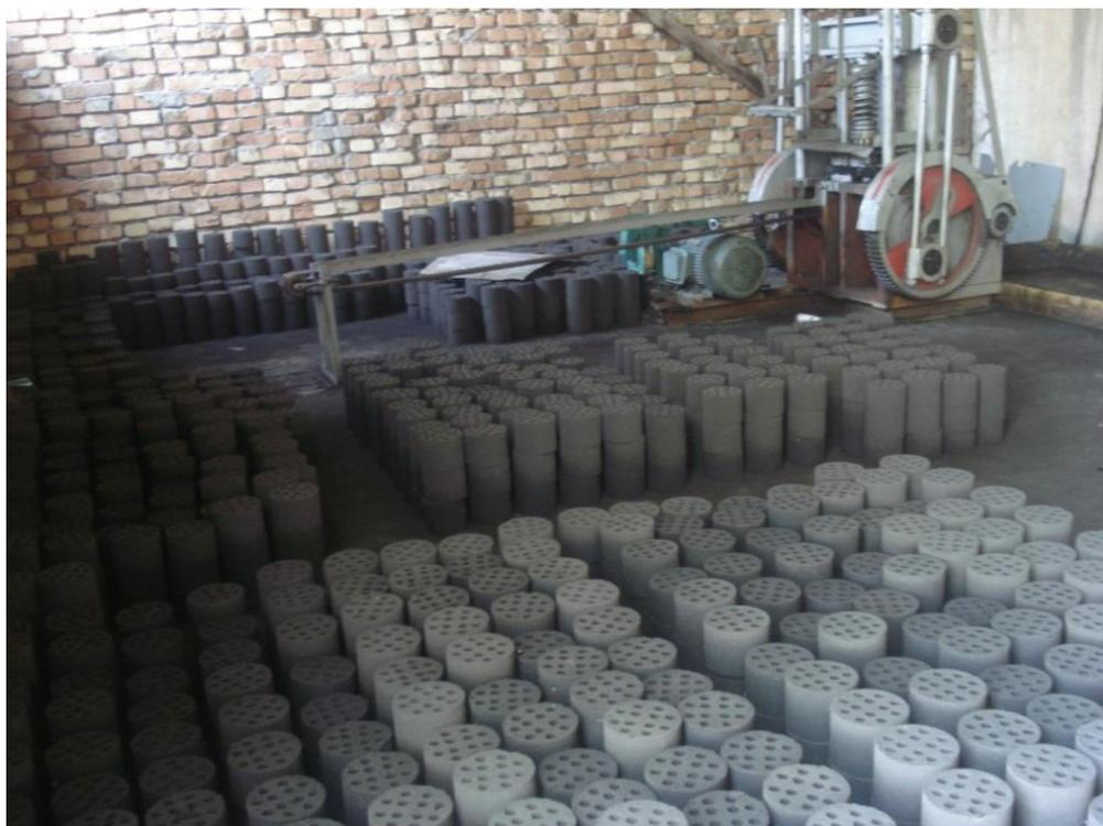
Рисунок 4.2 - Уплотнение смеси на специальном прессе в пресс-форме, брикеты со сквозными дырками.
