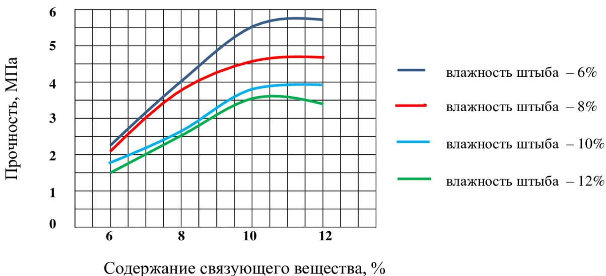
Рисунок 3.4 - Зависимость прочности брикетов от содержания связующего при разных влажностях штыба.
