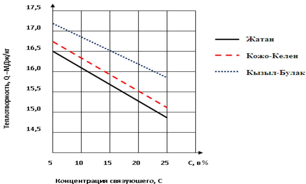
Рис.3.16 - Изменение теплотворности брикетов, в зависимости от концентрации связующего.
