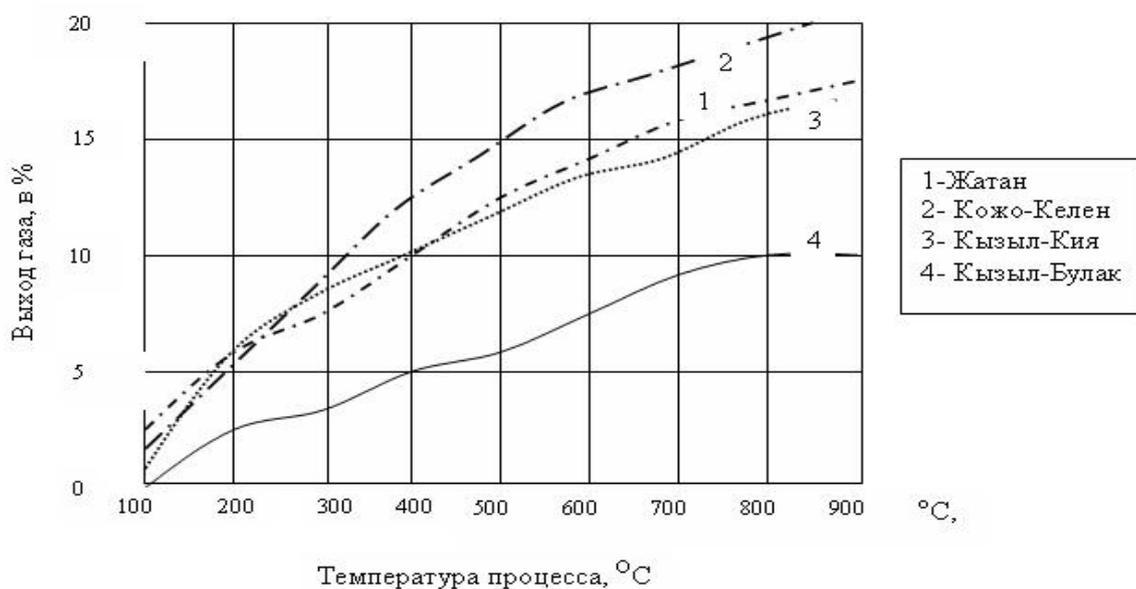
Рисунок 2.5 - Зависимость выхода газа от температуры.
