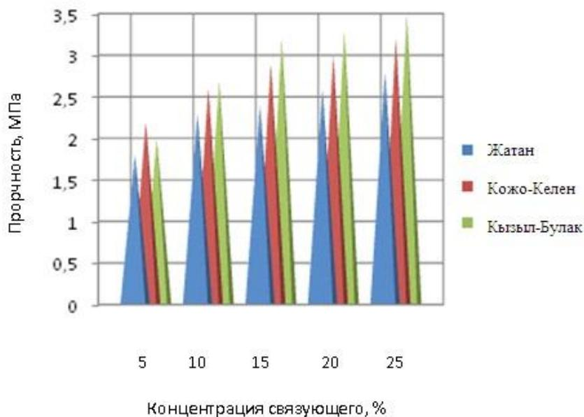
Рисунок 3.12 - Зависимость прочности  $P$  композиционного твердого топлива из исследуемых углей от концентрации лессового суглинка.
