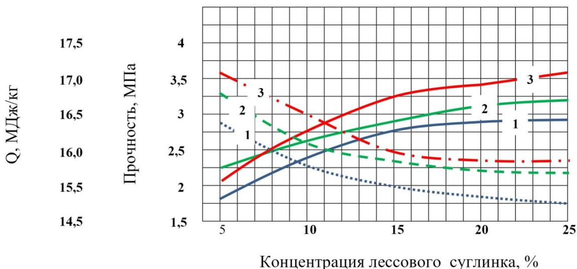
Рисунок 3.13 - Зависимость прочности Р и теплотворности Q КТТ от концентрации лессового суглинка С; 1- жиданский уголь, 2- кожокеленский уголь, 3- кызылбулакский уголь.
