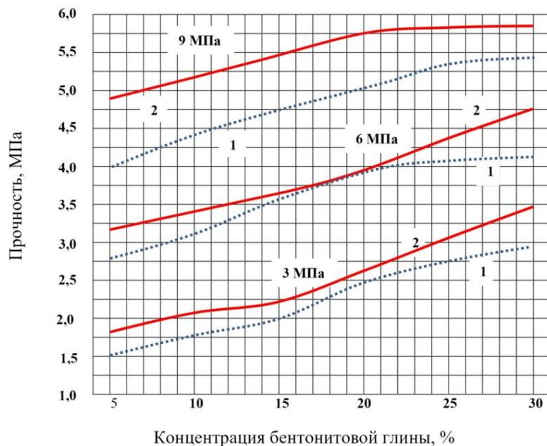
Рисунок 2.10 - Зависимость прочности окускованного топлива Р от давления прессования и от концентрации бентонитовой глины в шихте С: 1 – Жатанский уголь, 2 – Кожо-Келенский уголь.
