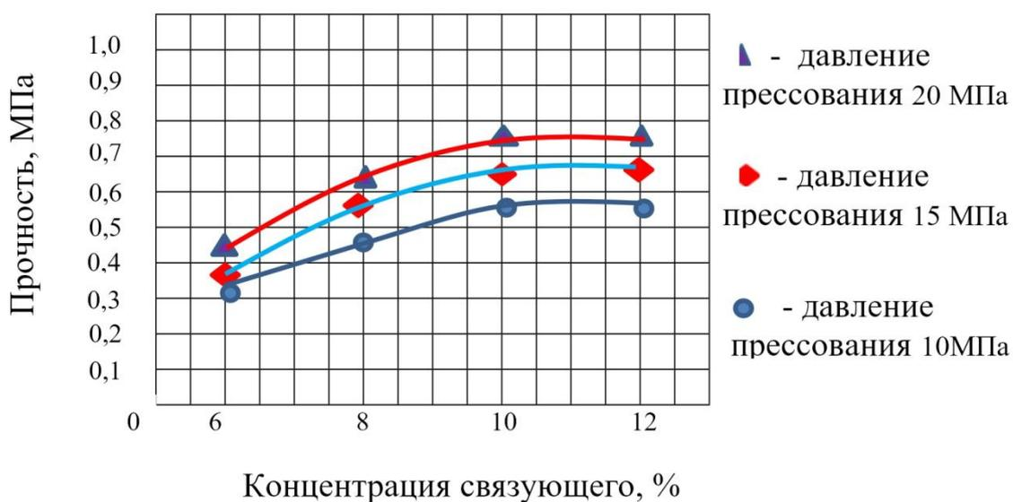
Рисунок 3.7 -Прочность брикета фракции 0-1мм на *изгиб* при концентрациях связующего 6, 8 и 10% и при давлении прессования 10, 15 и 20 МПа.
