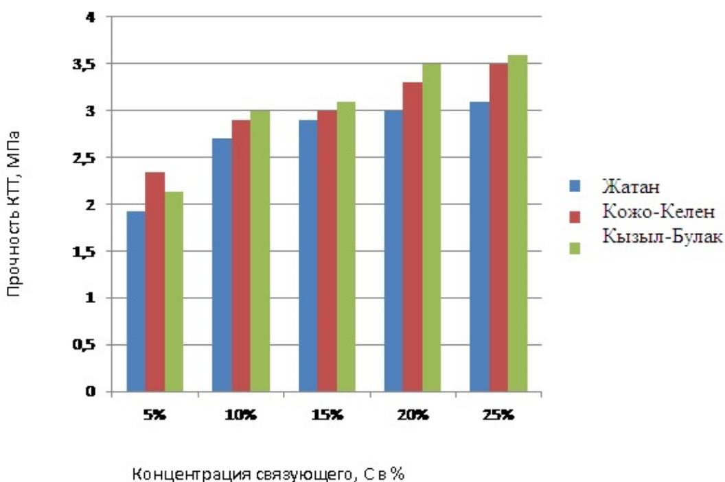
Рисунок 3.15 - Зависимость прочности Р КТТ от концентрации активированного лессового суглинка С; 1- жатанский уголь, 2- кожокеленский уголь, 3- кызылбулакский уголь.
