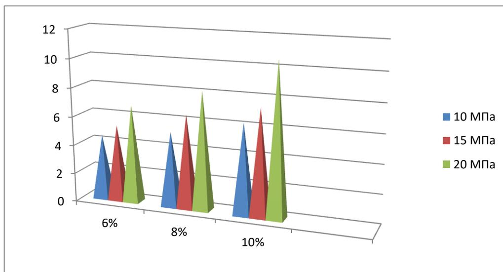
Рисунок 3.6 - Прочность брикета фракции 0-1мм на *сжатие* при концентрациях связующего 6, 8 и 10% и при давлении прессования 10, 15 и 20 МПа.
