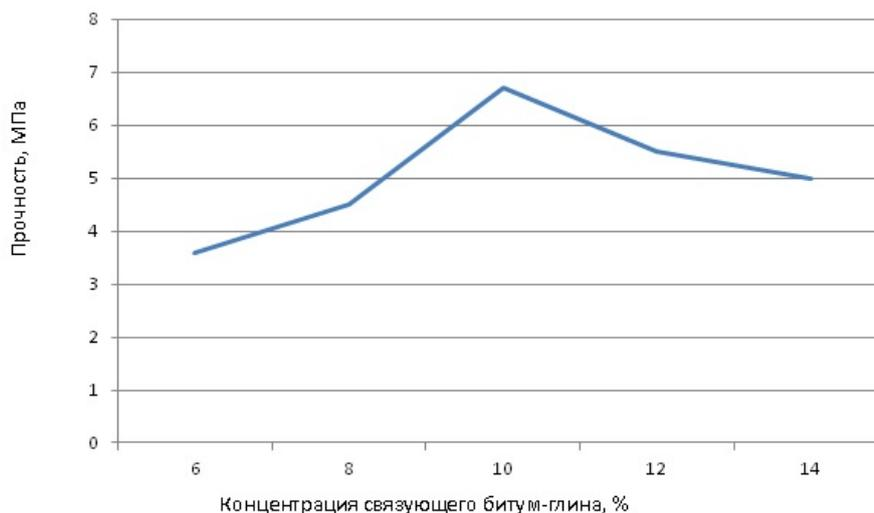
Рис. 3.18 - Зависимость прочности брикетов от концентрации связующих битум-глина.
