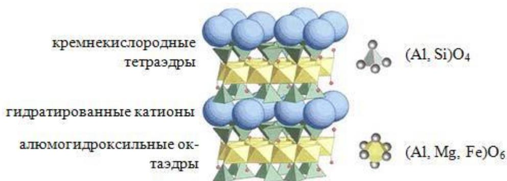
Рис. 2.7 – Структура монтмориллонита
