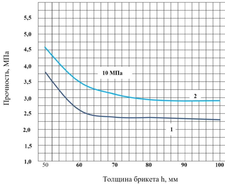
Рис. 2.9 - Зависимость прочности брикетов  $P$  от их толщины  $h$ : 1 - Жатанский уголь, 2 – Кожокеленский уголь
