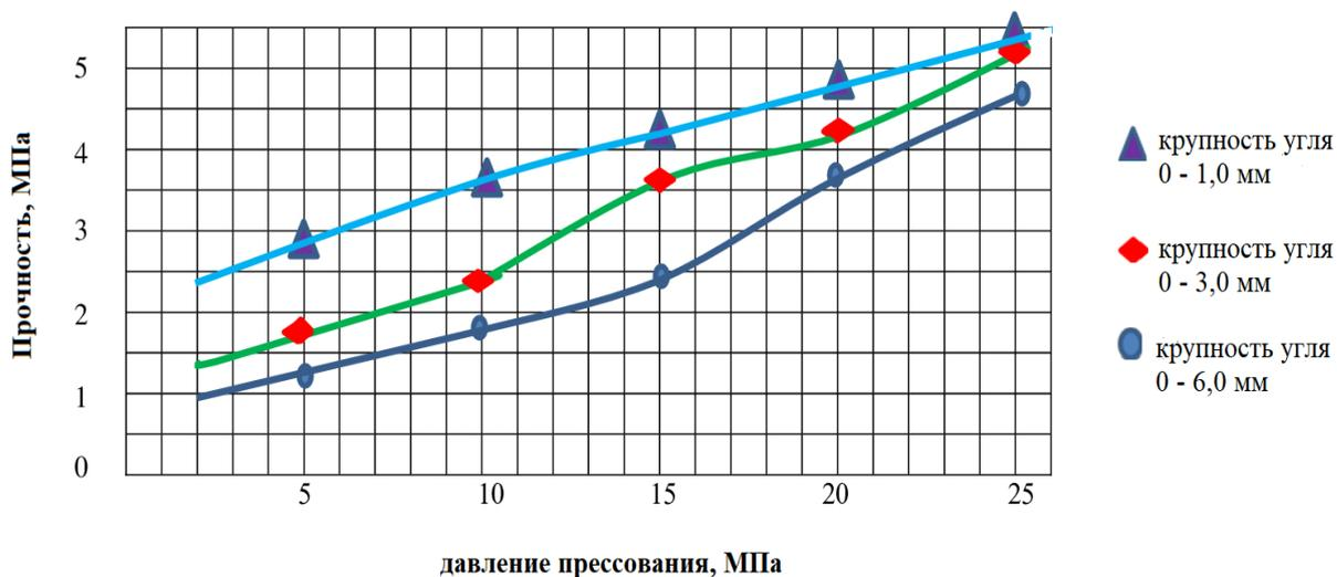
Рисунок 3.2 - Зависимость прочности кожо-келенского угля от давления прессования и от крупности угля (битум 10%, температура 100°С).
