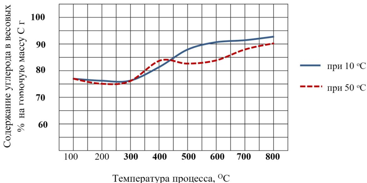
Рисунок 2.3 - Содержание углерода в твердых остатках полученных при различных скоростях нагрева Кожо-Келенского угля в весовых процентах
