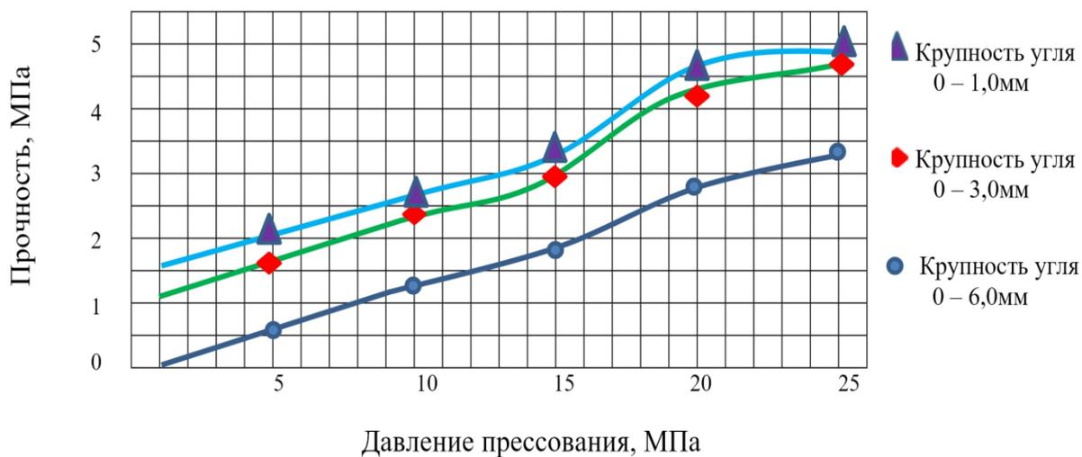
Рисунок 3.1 - Зависимость прочности брикета кызыл-булакского угля от давления прессования и от крупности угля (битум 10%, температура 100°С).
