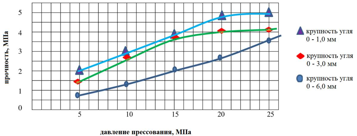
Рисунок 3.3 - Зависимость прочности брикета жатанского угля от давления прессования и от крупности угля (битум 10%, температура 100°C).
