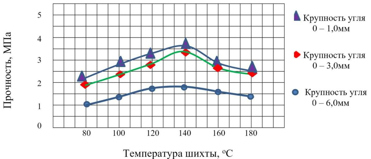
Рисунок 3.4 - Зависимость прочности брикета от температуры шихты (битум 10%).
