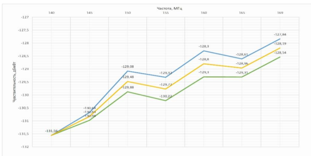
Рисунок 3.7 - Чувствительность радиоприёмного тракта РЛС П-18М
