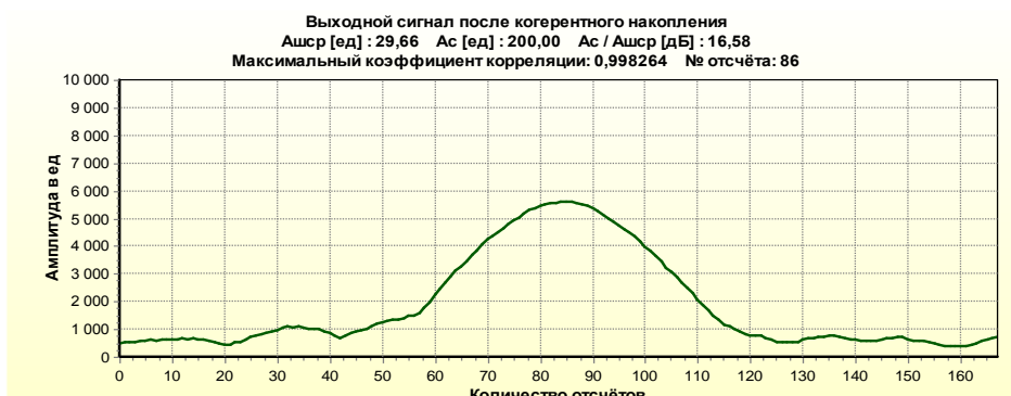
Рисунок 2.10 – Вид диаграммы при коэффициенте корреляции 0,998
