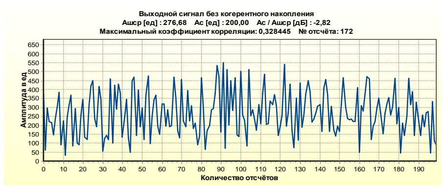
Рисунок 2.11 – Вид сигнала при отношении сигнал/шум -2,82 дБ
