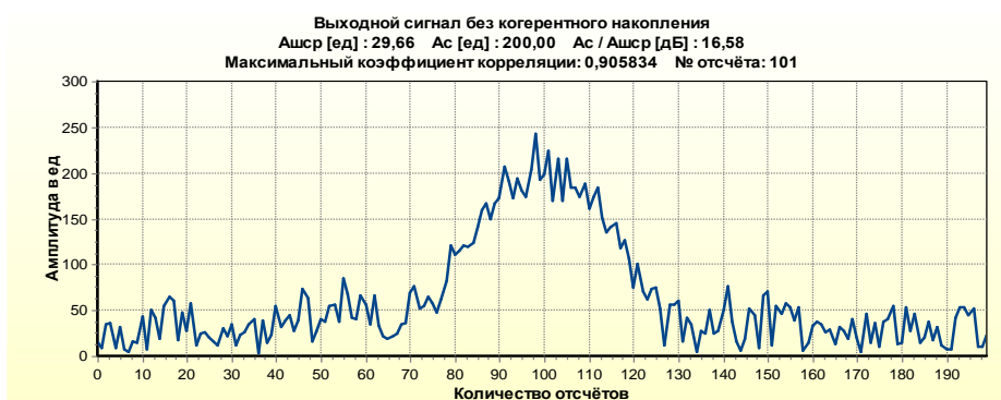
Рисунок 2.9 – Вид сигнала при коэффициенте корреляции 0,9
