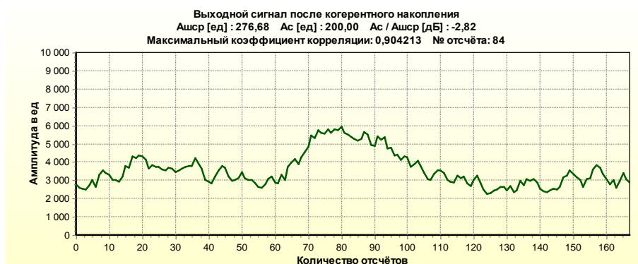
Рисунок 2.12 – Вид сигнала после применения когерентного накопления
