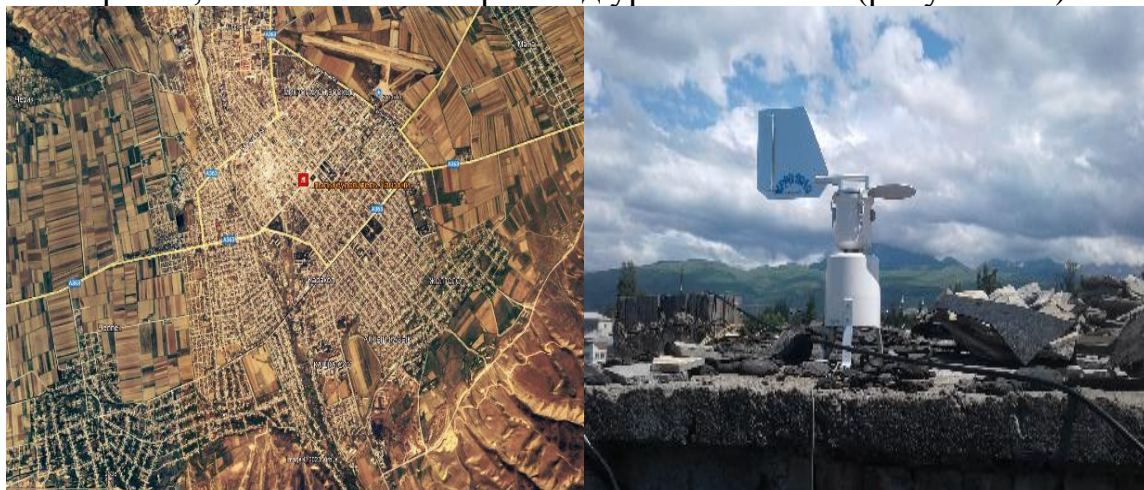
Рисунок 2.1 – Ловушка Ланзони в г. Каракол, на крыше здания
