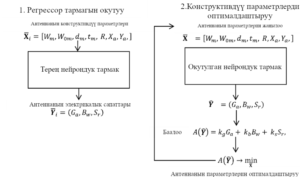
4-сүрөт – CSRR клеткаларынын оптимальдуу конструкциясын издөө схемасы микроролосалуу антенна
