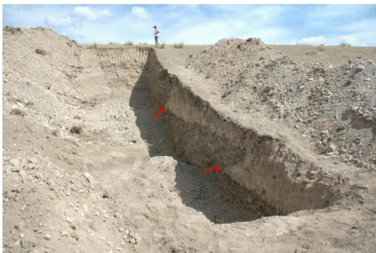
Рисунок. 3.1. Вид траншеи, пройденной через уступ Центрально-Нарынского разлома – красными стрелочками отмечены вскрытые плоскости разрывов. Видна разметка с шагом 1 метр
