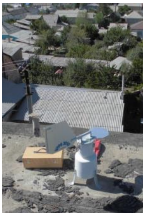
Рисунок 2.2.1 – Ловушка Ланзони на крыше здания
