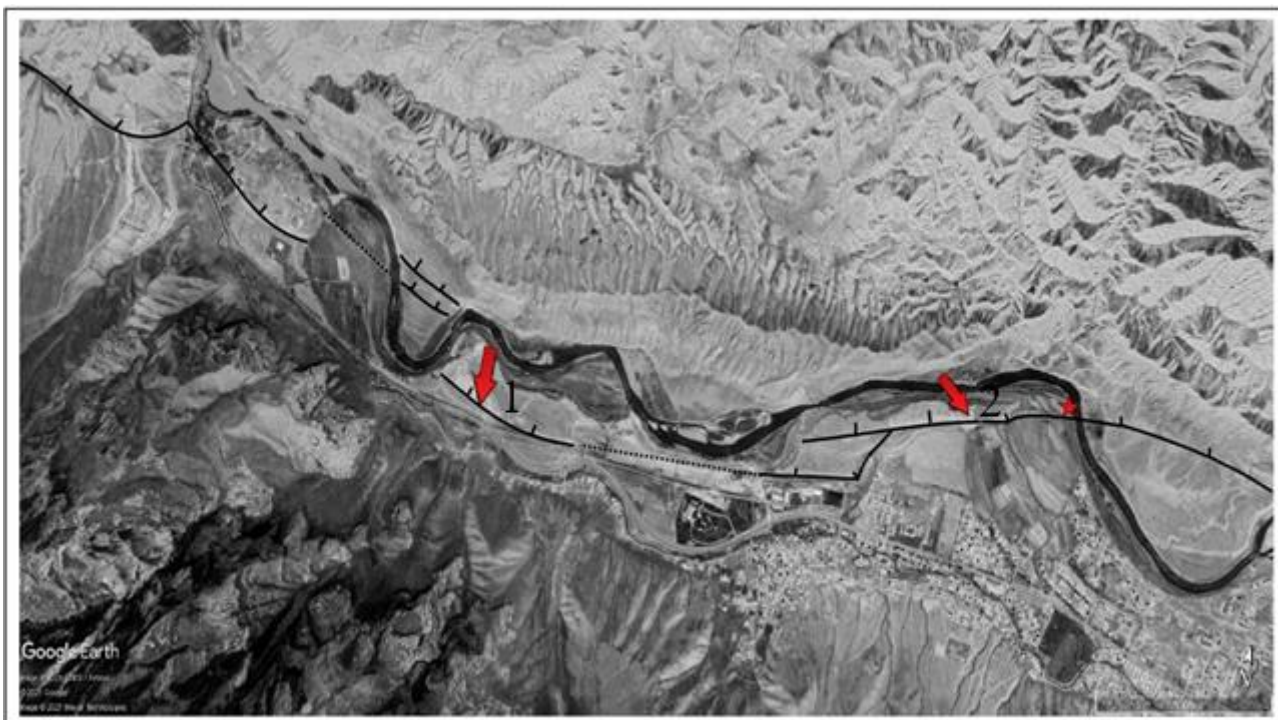
Рисунок 3.20 - Активные разломы в пределах стройплощадки Университета. Красные стрелки - положение траншей. Цифры – номера траншей. Красная звездочка – места отбора образцов в уступе первой террасы р. Нарын.
