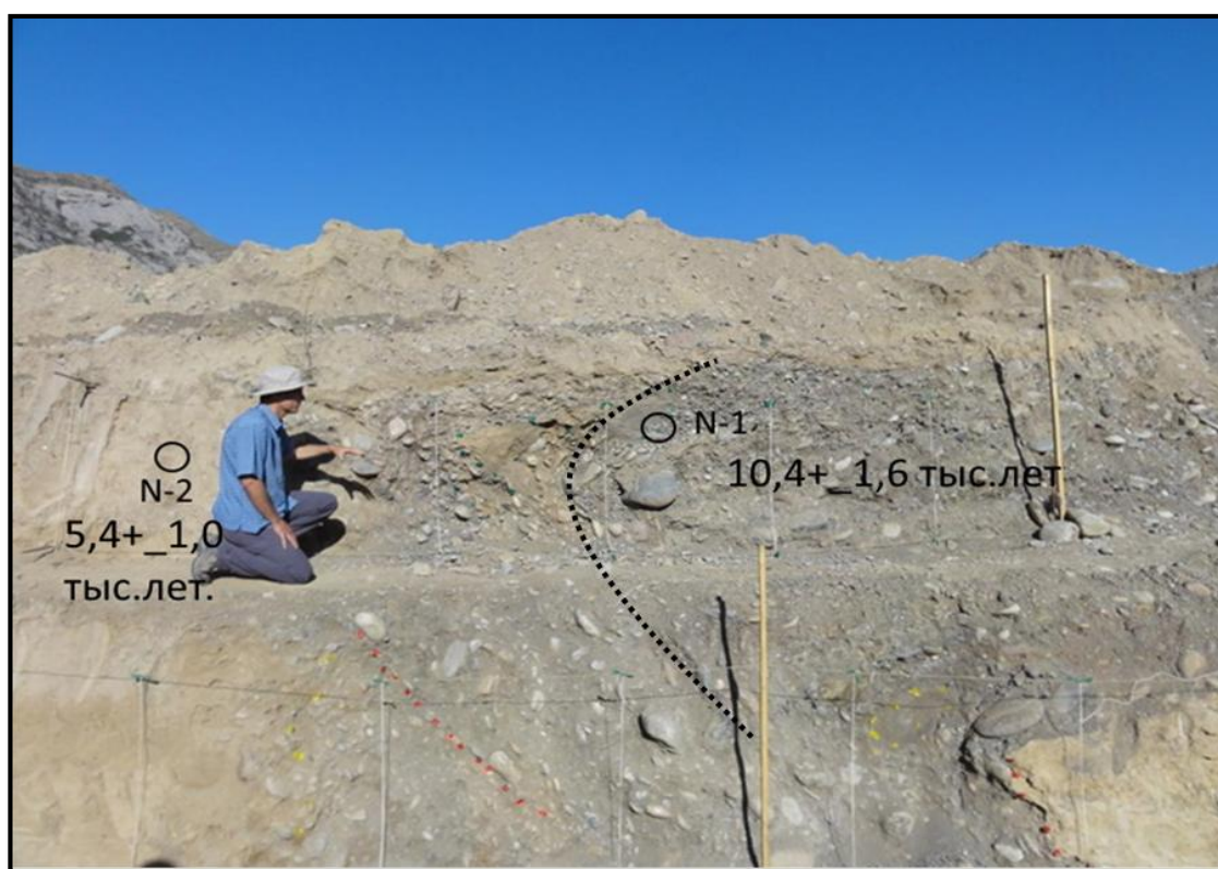
Рисунок 3.1.2.3 - Места отбора образцов на термолюминисцентный анализ. Цифры - возраст в тысячах лет назад. Пунктирная линия - деформация аллювиальных отложений. Красными точки - положение разрывов.
