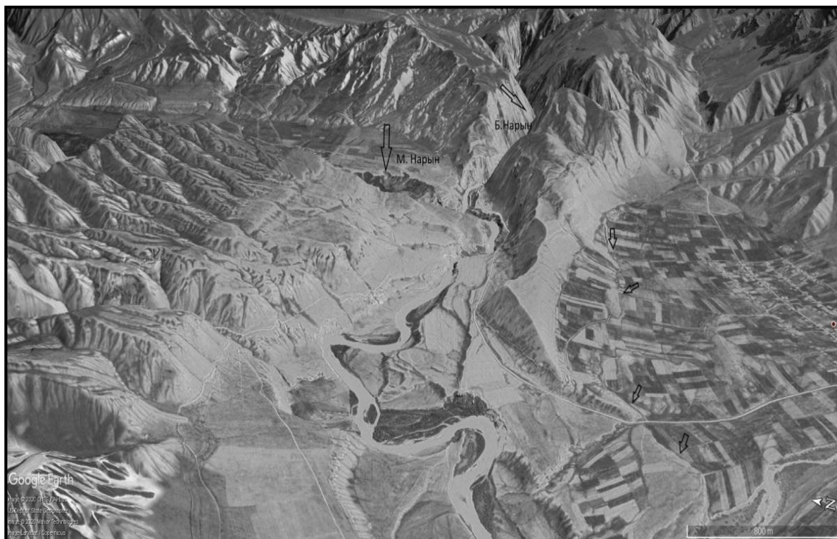
Рис. 3.13 - Трехмерное изображение, antecedentного поднятия, в висячем крыле Центрально-Нарынского разлома. Вид на восток. Стрелки – линия разлома
