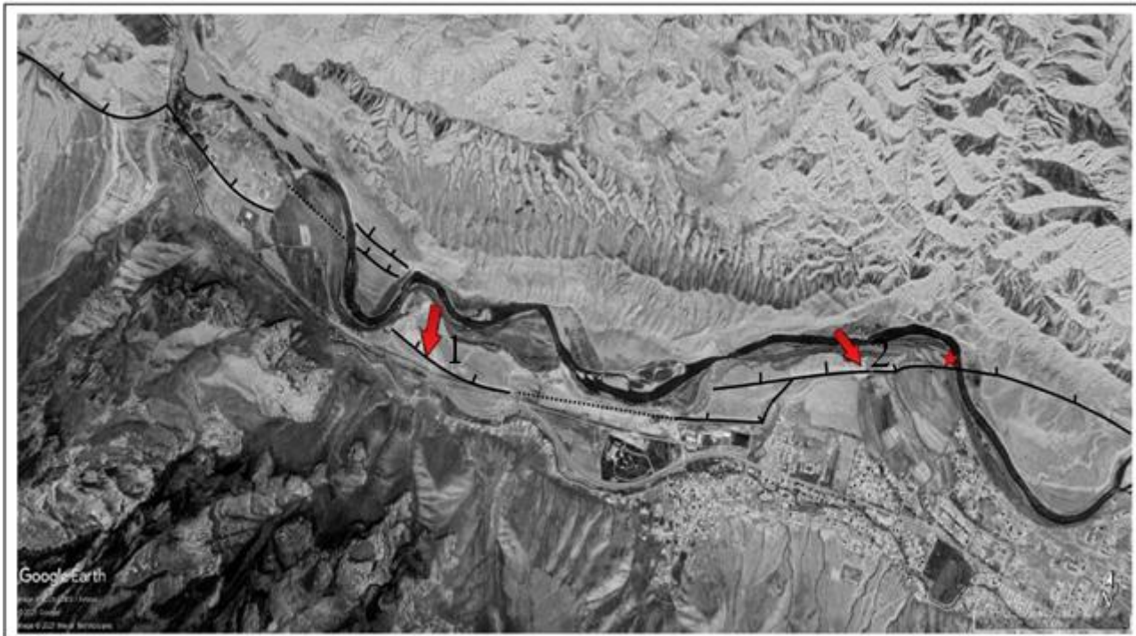
Рисунок 3.20 - Активные разломы в пределах стройплощадки Университета. Красные стрелки - положение траншей. Цифры – номера траншей. Красная звездочка – места отбора образцов в уступе первой террасы р. Нарын.
