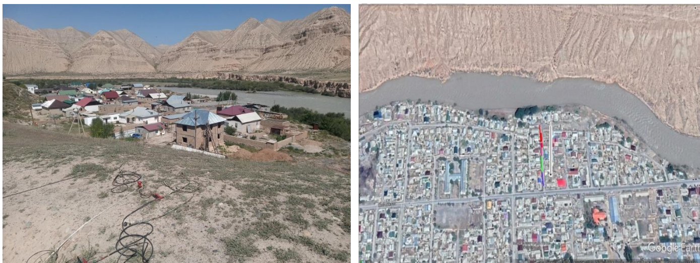
Рисунок 2.1.1.12 - На правом фото поднятое крыло разлома, жилые дома стоят на сброшенном крыле (на ближнем плане с фрагментами сейсмической косы), размытое деятельностью реки Нарын, обозначен линия профиля, на левом фото место геофизического профиля, №6 (координатами \varphi = 41^{\circ}25'47.03'' , \lambda = 75^{\circ}58'28.81'' ) (составлен автором).
