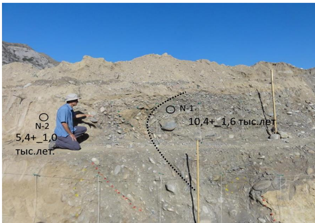
Рисунок 3.1.2.3 - Места отбора образцов на термолюминисцентный анализ (составлен автором). Цифры - возраст в тысячах лет назад. Пунктирная линия - деформация аллювиальных отложений. Красными точки - положение разрывов.
