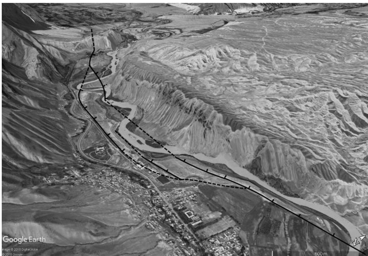
Рисунок 2.1.1.28 - Активные разломы в западной части г. Нарын. Бергштрихами показано падение сместителей разломов. Вид с юго-востока. Изображение из Google Earth
