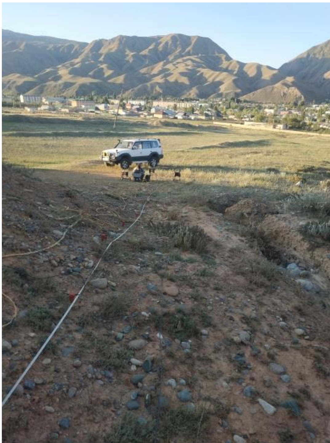
Рисунок 2.1.1.4 - Сейсмическая коса с шагом между пунктами приема 1,5 м., на склоне го Работа проводилась на территории города Нарын на 9 участках, для определения расположения разлома:
