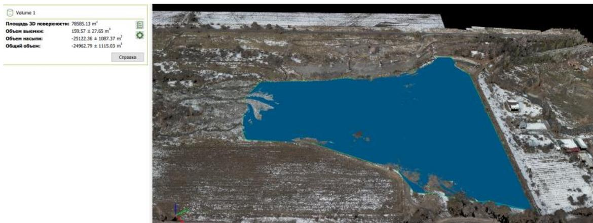
Рис. 4.14. Расчет объема водораспределителя, с. Кашка-Суу
