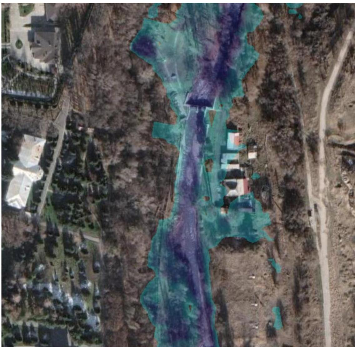
Рис. 6.3. Зона поражения, участок гидросооружения (Чон-Арык) – расход  $70 \text{ м}^3/\text{с}$
