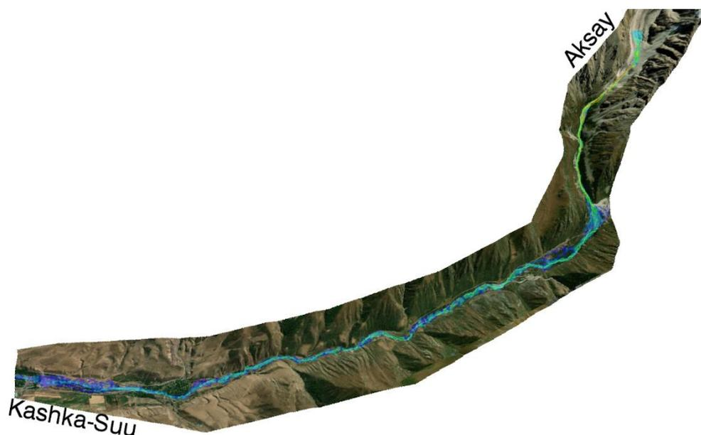
Рис.4.15. Пример моделирования прорыва озера Аксай в программе RAMMS
