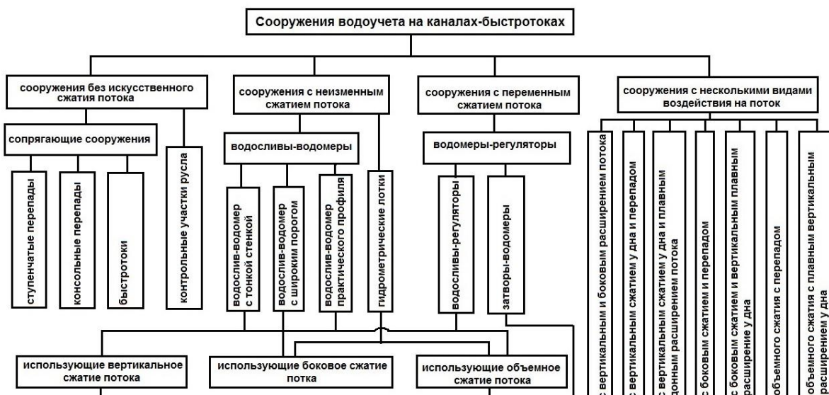
Рисунок 2 - Сооружения водоучета на каналах-быстротоках
