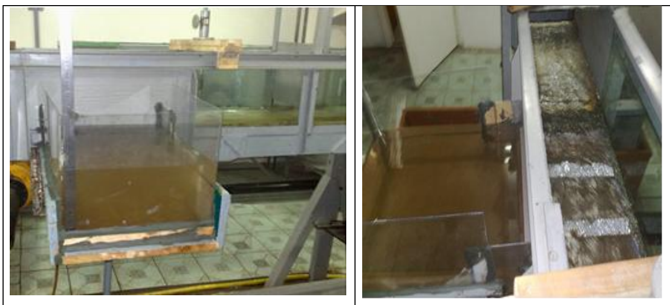
Рис. 5.15 Экспериментальный гидравлический лоток (ЭГЛ) в лаборатории техноцентра КРСУ.
