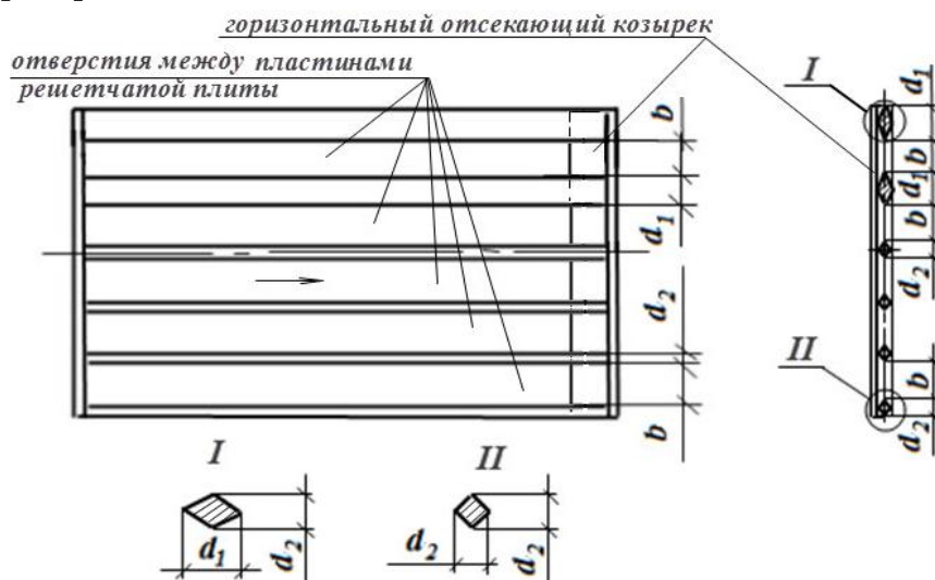
Рисунок 3.22 – «Ассиметричная решетчатая плита с продольными отверстиями одинаковой ширины, но с разной шириной пластин (прутьев)»[129]
