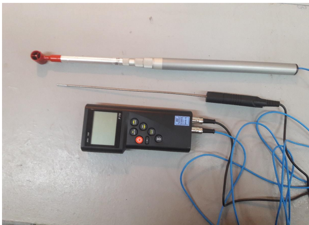
Рис.5.11 Универсальный инструмент Precision Measuring Instruments серии P700, для измерения скорости потока
