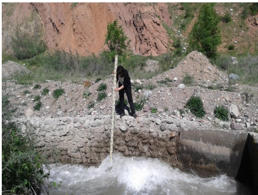
Рисунок 4.5 – Измерение глубин на поворотном участке канала «Жетиген»
