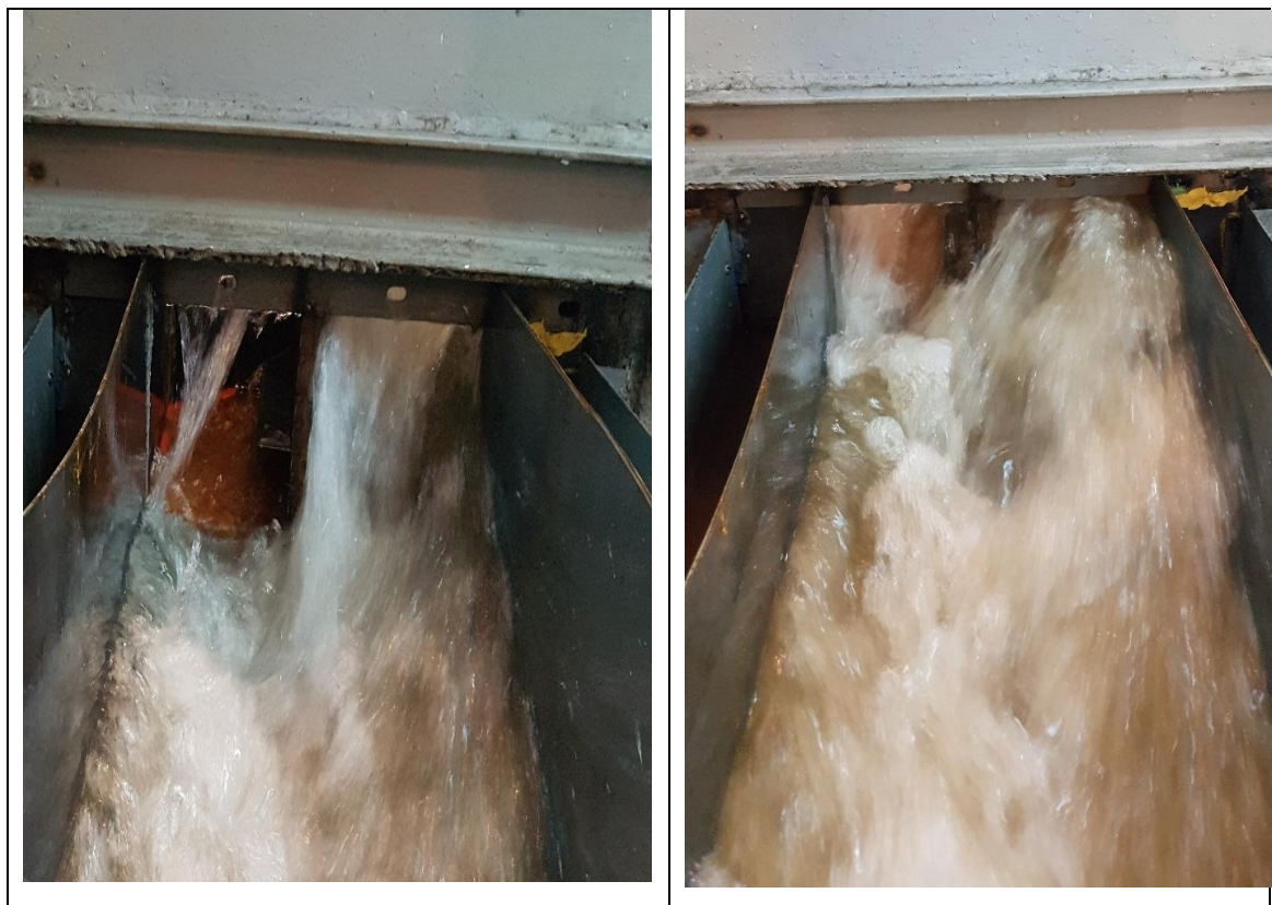
Рисунок 4.23 – Истечения через поворотное сооружение в отводящий лоток при расходах воды: а) при Q = 0,54Q_{max} ; б) Q = Q_{max}
