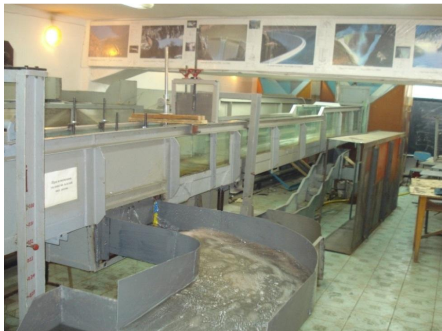
Рисунок 3.15 - ЭГЛ с моделью вододелителя в процессе исследований в лаборатории техноцентра КРСУ
