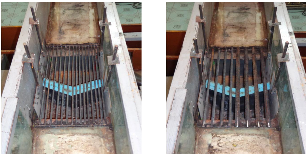
Рисунок 3.23 - Установка вододелителей: а) ВДКБТ-АР с увеличивающимися зазорами между прутьями решетки; б) ВДКБТ-АП с продольными одинаковыми по ширине отверстиями, но с разной шириной пластин решетки
