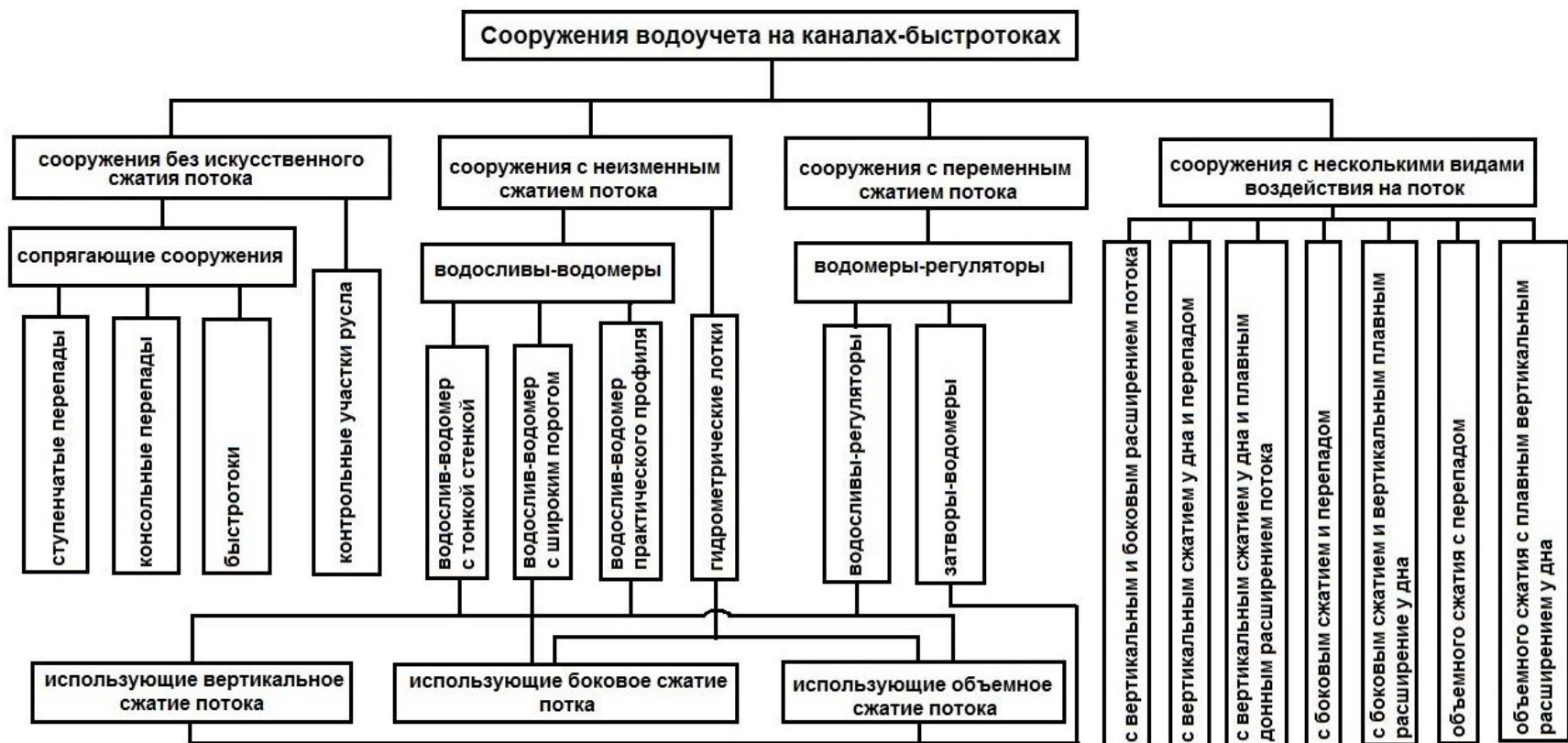
Рисунок 1.5 – Сооружения водоучета на каналах-быстроотоках
