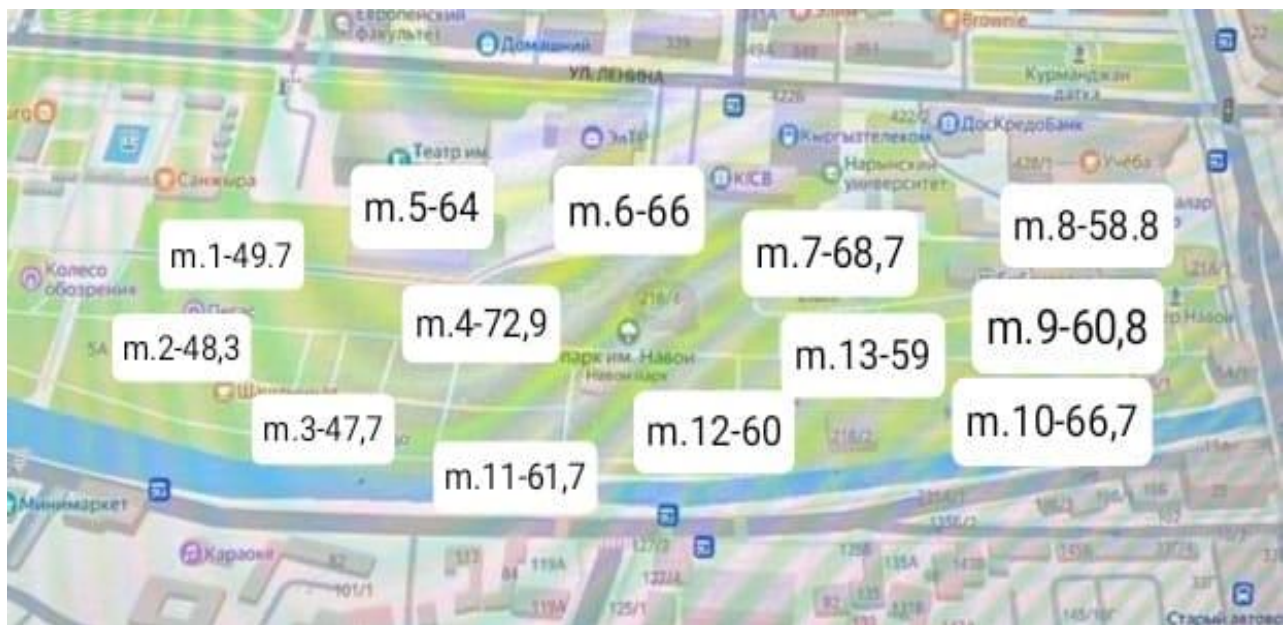
Рисунок 3.3.3.1 - Карта уровня шума в парке А. Навои (указан эквивалентный уровень звука, дБА)
