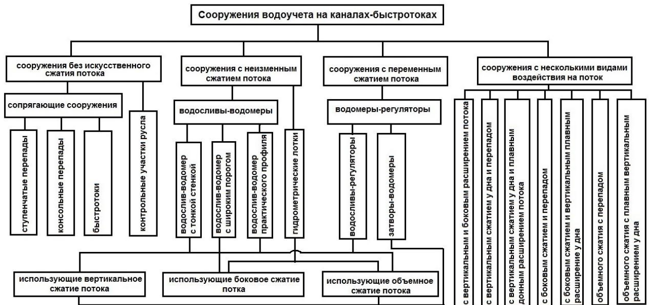
Рисунок 2 - Сооружения водоучета на каналах-быстроотоках
