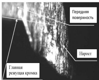
Рисунок 3.4 - Нарост на уголке сверла
