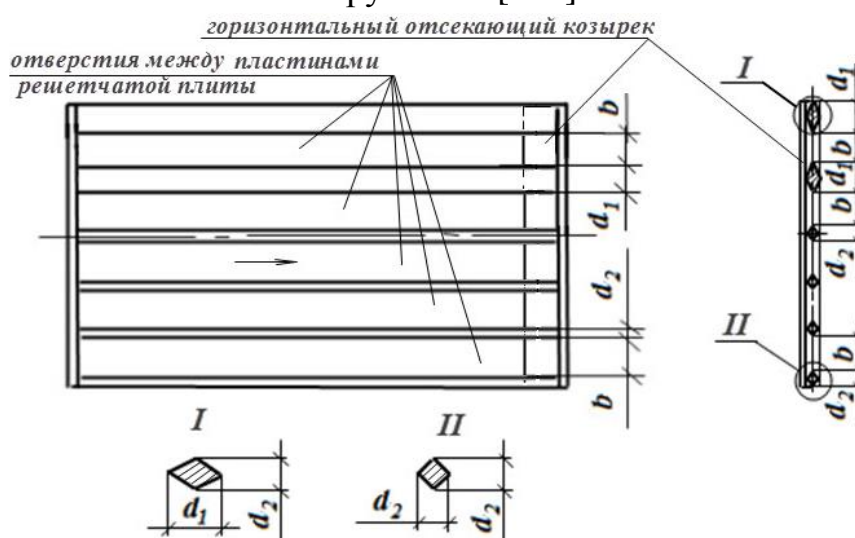
Рисунок 3.21 – «Ассиметричная решетчатая плита с продольными отверстиями одинаковой ширины, но с разной шириной пластин (прутьев)»[135]
