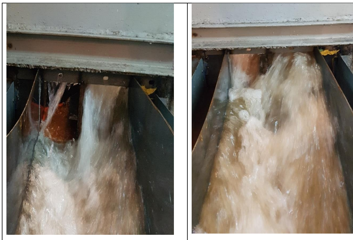
Рисунок 4.23 – Истечения через поворотное сооружение в отводящий лоток при расходах воды: а) при Q = 0,54Q_{\max} ; б) Q = Q_{\max}
