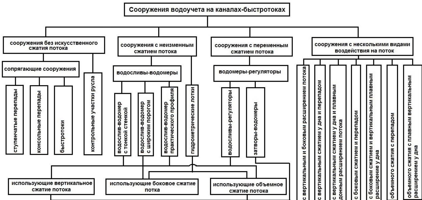
Рисунок 1.4 –Сооружения водоучета на каналах-быстротоках
