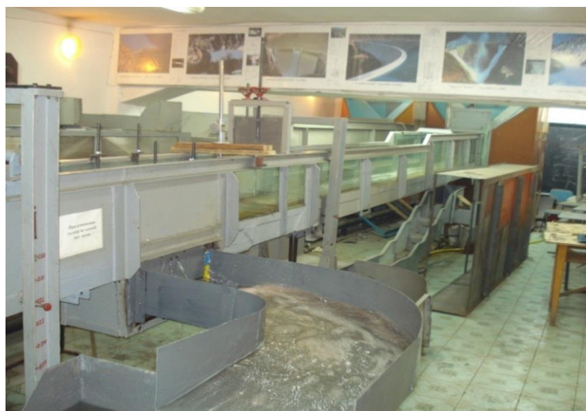
Рисунок 3.15 - ЭГЛ с моделью вододелителя в процессе исследований в лаборатории техноцентра КРСУ
