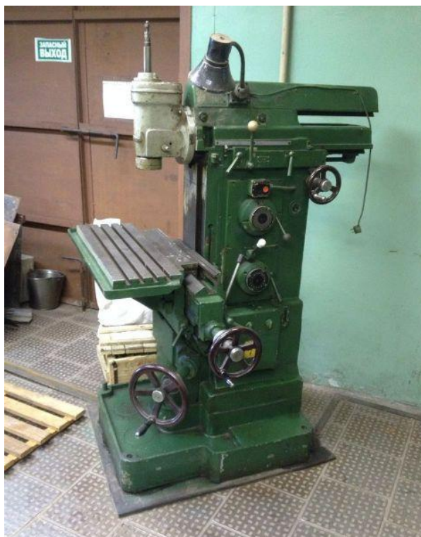
Рисунок 2.1 - Широкоуниверсальный фрезерный станок повышенной точности модели 675П
