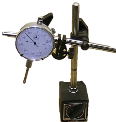
Рисунок 2.5 – Микрометр часового типа на магнитном штативе
