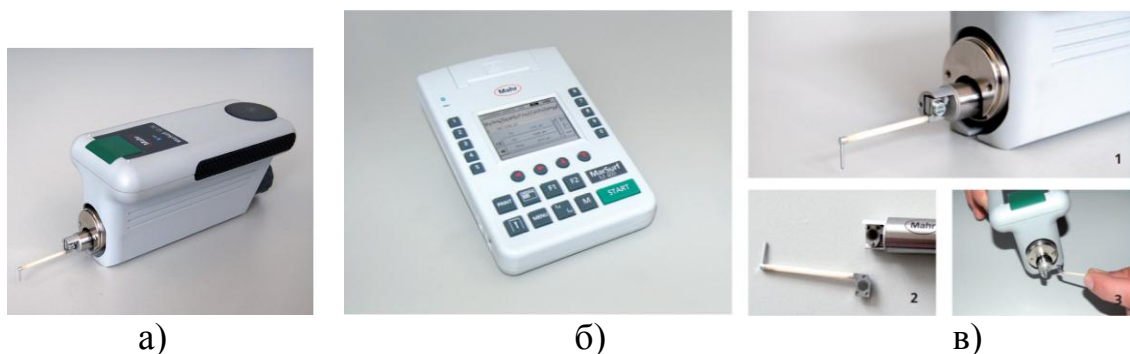
Рисунок 2.10 - Прибор для измерений шероховатости поверхности MarSurf M 400: а – блок привода SD26; б – прибор MarSurf M 400; в – рычаг датчика с магнитным держателем
