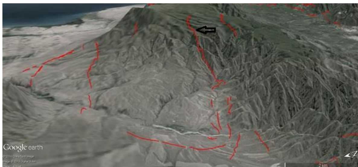
Рисунок 3.1.22 – Вид на активные разрывы восточной части зоны Лепсинского разлома с запада (долина р.Тентек на переднем плане) (Изображение Google Earth). Стрелкой показано положение фото на рис. 3.1.23.
