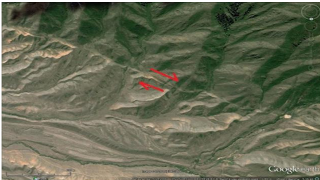
Рисунок 3.1.34 – Активный разлом в долине р. Тохты. Отчетливо видны правосдвиговые смещения временных потоков до 50 – 100 м.
