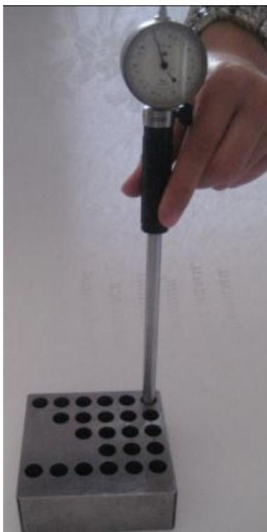
Рисунок 2.7 – Контроль качества допуска
