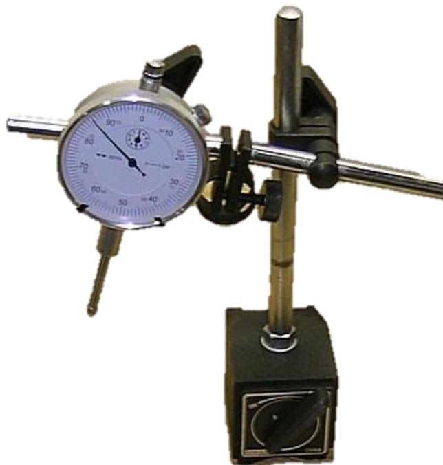
Рисунок 2.5 – Микрометр часового типа на магнитном штативе
