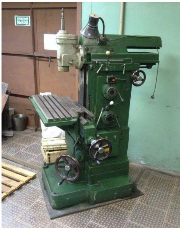
Рисунок 2.1 - Широкоуниверсальный фрезерный станок повышенной точности модели 675П
