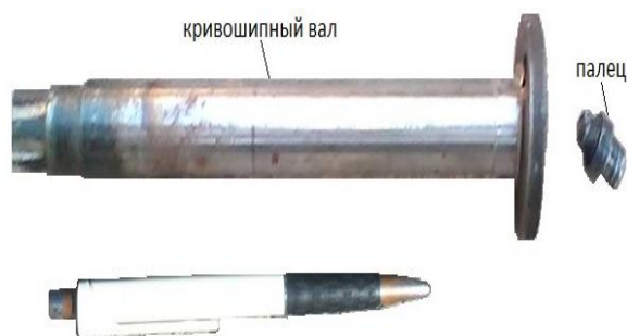
Рисунок 13 - Поломка кривошипного вала перфоратора
