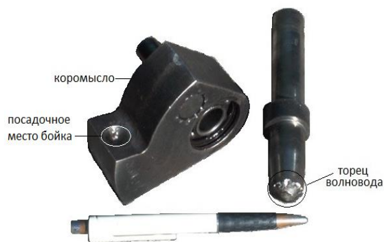
Рисунок 12 - Поломки коромысла и волновода опытного образца перфоратора
