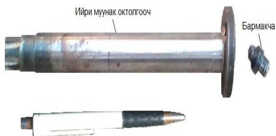
13 - сүрөт. Перфоратордун ийри муунак октолгоочунун сынышы
