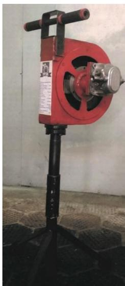
Рисунок 5.7 - Ударный механизм с гидравлическим приводом
