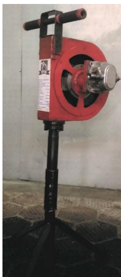
Рисунок 5.7 - Ударный механизм с гидравлическим приводом
