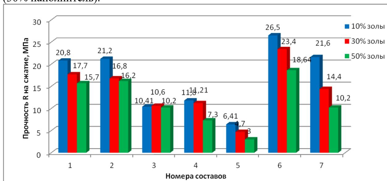
Рисунок 4 - Прочность 28 суток МЗБ на ЦЗВ<sub>и</sub> и заполнителя из топливного шлака
