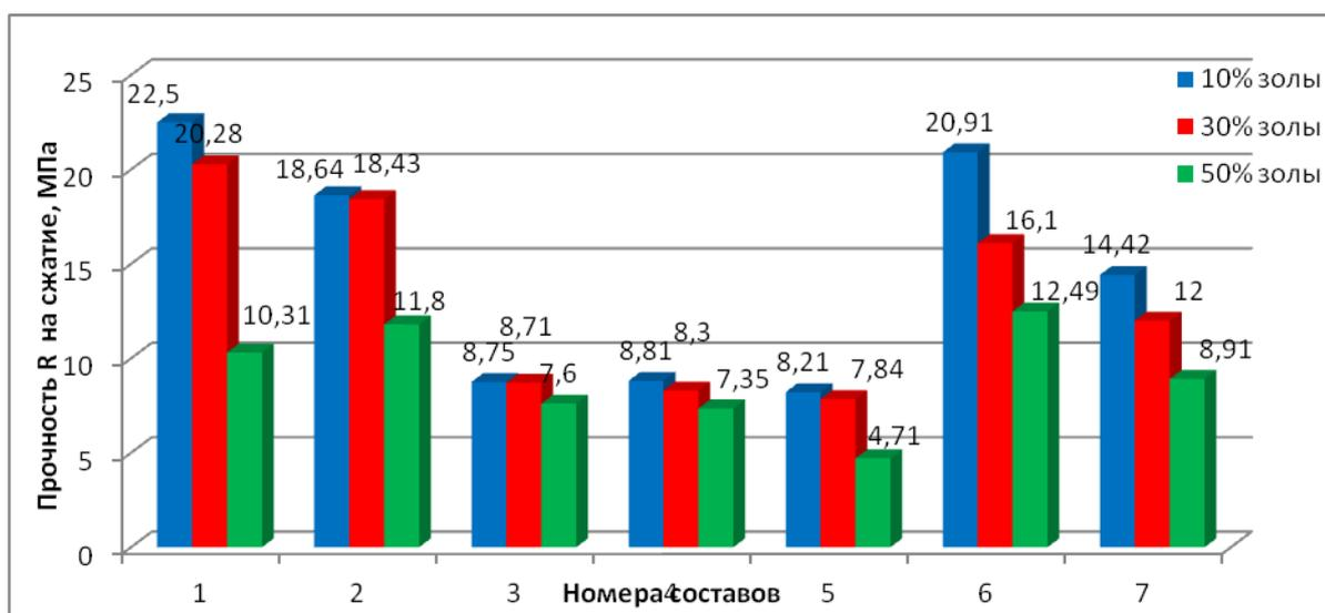
Рисунок 5 - Прочность МЗБ на ЦЗШВ после 28 суток твердения
