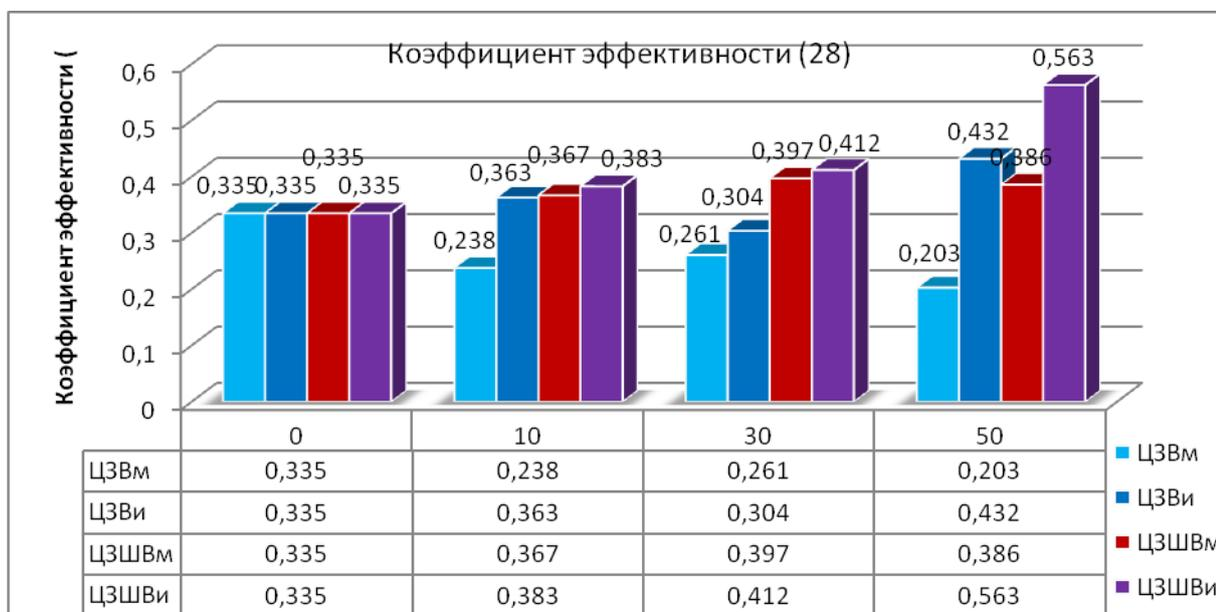
Рисунок 3 - Коэффициент эффективности ( $K_{эф}$ ) использования цемента в вяжущих после 28 суток твердения: ЦЗВ<sub>м</sub>, ЦЗВ<sub>и</sub>, ЦЗШВ<sub>м</sub>, ЦЗШВ<sub>и</sub>
