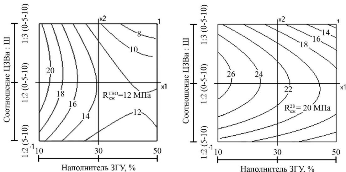
Рисунок 6 - Номограмма прочности после ТВО и 28 суток МЗБ на ЦЗВ<sub>и</sub>
