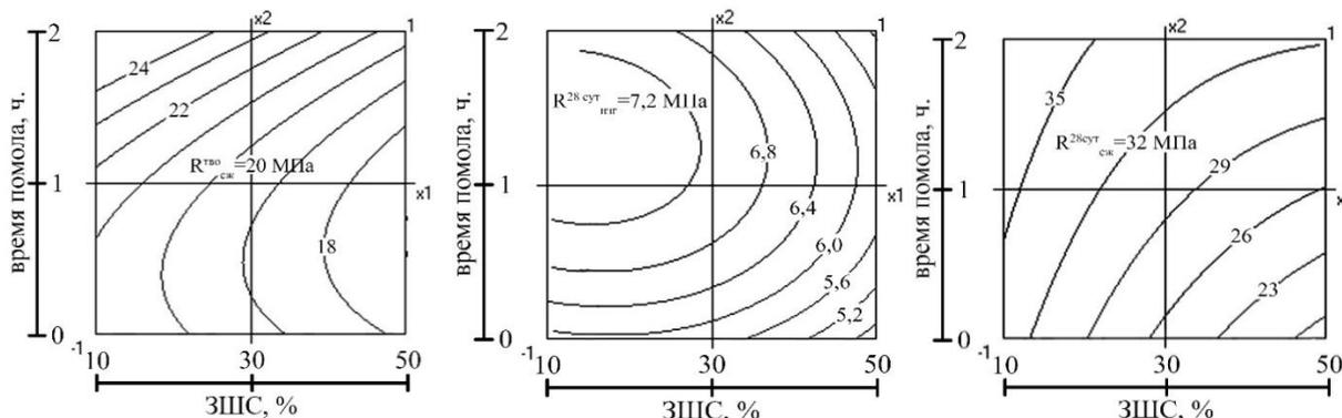
Рисунок 2 - Прочность после ТВО ( $R^{\text{TBO}}_{\text{сж}}$ ), при 28 сутках изгиб ( $R^{28\text{сут}}_{\text{изг}}$ ), сжатие ( $R^{28\text{сут}}_{\text{сж}}$ ) образцов цементнозолошлакового вяжущего ЦЗШВ
