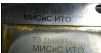
Рисунок 8 – Лазерная цветная маркировка хромистого покрытия
