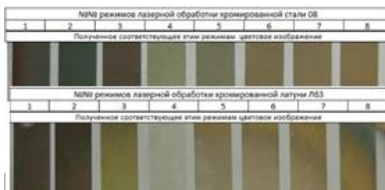
Рисунок 9 – Воспроизведение цветовых изображений, полученных на хромированных поверхностях, стали 08 и латуни L63
