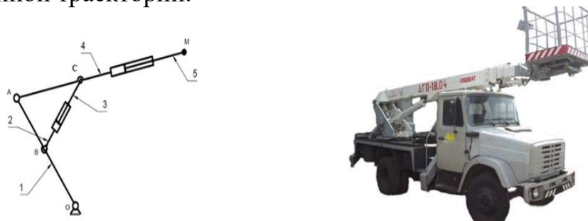
Рисунок 12 - Схема автоподъемника с двумя линейными приводами: 1-двухпарное звено, 2,4 - цилиндр, 3,5 - шток, 5- рабочий орган.
