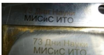
Рисунок 8 – Лазерная цветная маркировка хромистого покрытия
