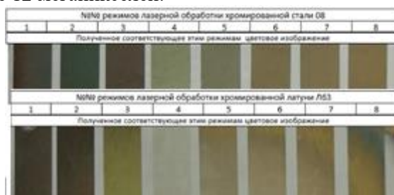
Рисунок 9 – Воспроизведение цветовых изображений, полученных на хромированных поверхностях стали 08 и латуни Л63
