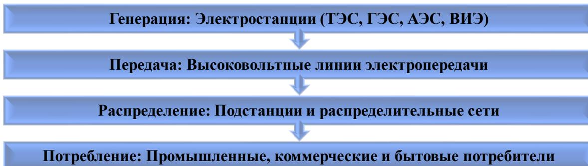
**Рисунок 1.1. Элементы функционирования энергетической системы**
