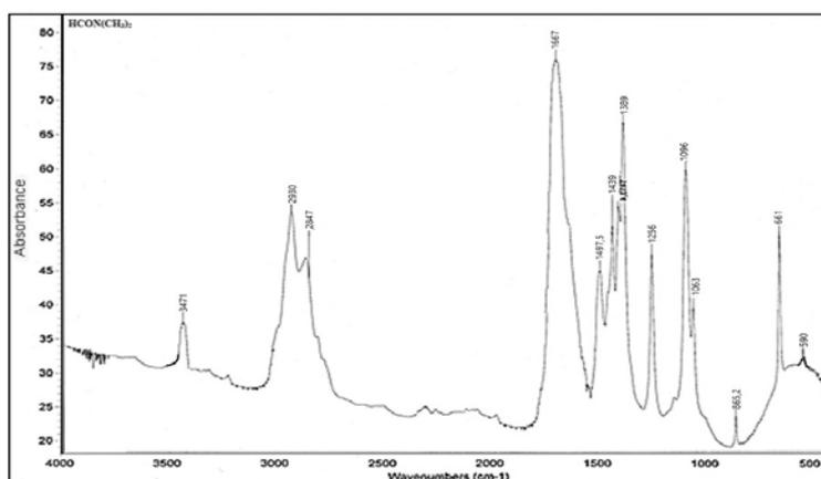
Рисунок 3.4 - ИК-спектры поглощения  $\text{HCON}(\text{CH}_3)_2$
