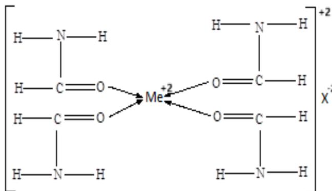
Рисунок 3.7 - Предполагаемая структура комплексов типа:  $\text{MeX} \cdot 4\text{HCONH}_2$ , (где  $\text{Me} = \text{Mg}^{2+}, \text{Ca}^{2+}, \text{Cu}^{2+}, \text{Zn}^{2+}$ ), (где  $\text{X} = 2\text{Cl}^-, \text{SO}_4^{2-}$ )
