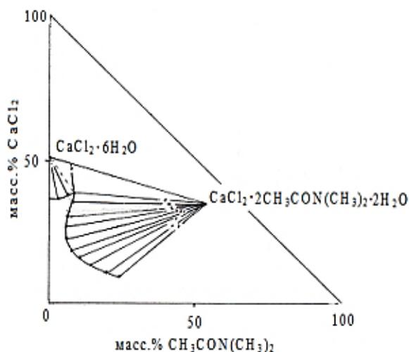
Рисунок 3.2. - Изотерма растворимости системы  $\text{CaCl}_2 - \text{CH}_3\text{CON}(\text{CH}_3)_2 - \text{H}_2\text{O}$  при  $25^\circ\text{C}$
