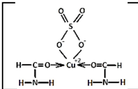
Рисунок 3.6 - Предполагаемая структура комплексов типа:  $[\text{CuSO}_4 \cdot 2\text{HCONH}_2]$
