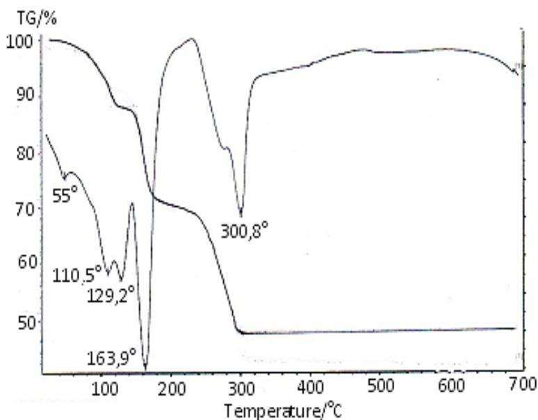
Рисунок 3.9 - Дериватограмма соединения  $\text{CaCl}_2 \cdot 2\text{HCON}(\text{CH}_3)_2 \cdot 2\text{H}_2\text{O}$
