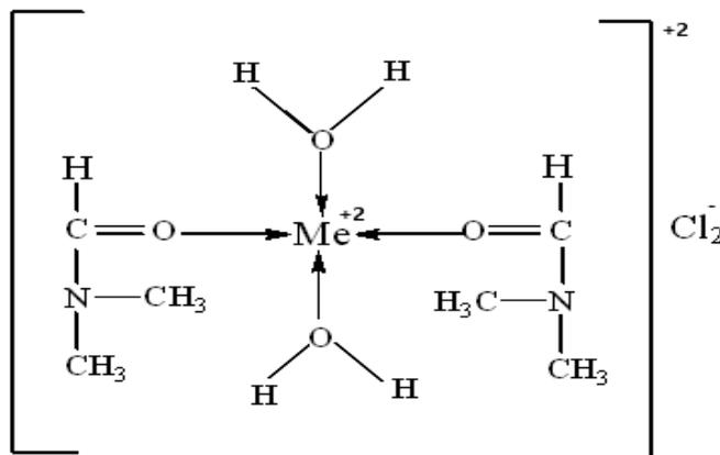
Рисунок 3.8 - Предполагаемая структура комплексов типа:  $\text{MeCl}_2 \cdot 2\text{HCON}(\text{CH}_3)_2 \cdot 2\text{H}_2\text{O}$  (где  $\text{Me} = \text{Mg}^{2+}, \text{Ca}^{2+}$ )
