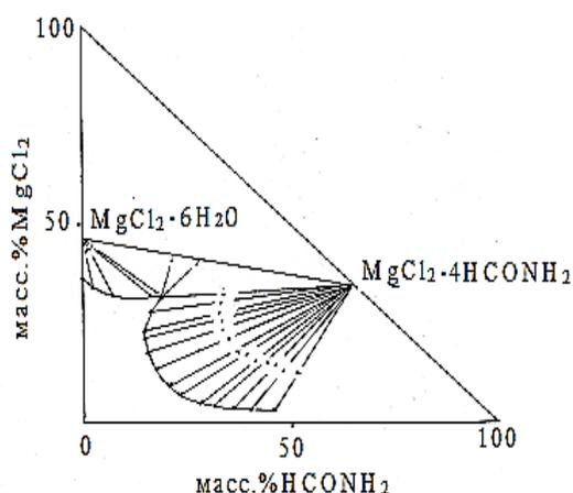
Рисунок 3.1 - Изотерма растворимости системы  $\text{MgCl}_2 - \text{HCONH}_2 - \text{H}_2\text{O}$  при  $25^\circ\text{C}$
