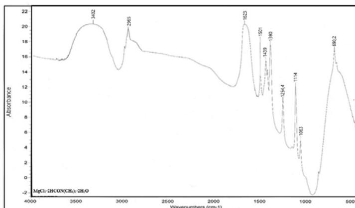
Рисунок 3.5 - ИК-спектры поглощения соединения  $\text{MgCl}_2 \cdot 2\text{HCON}(\text{CH}_3)_2 \cdot 2\text{H}_2\text{O}$
