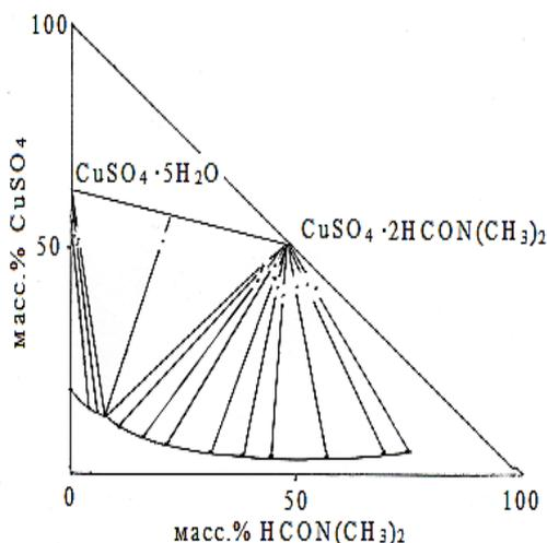
Рисунок 3.3 - Изотерма растворимости системы  $\text{CuSO}_4 - \text{HCON}(\text{CH}_3)_2 - \text{H}_2\text{O}$  при  $25^\circ\text{C}$
