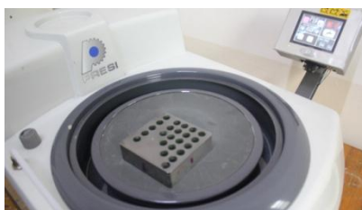
Рисунок 2.10 - Полировочная установка «PRESI Mintech 233»
