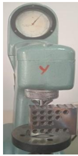
Рисунок 2.12 – Измерение твердости, обработанной сверлением
