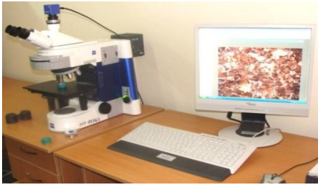
Рисунок 2.11 - Световой микроскоп Axio Imager A1m/M1m
