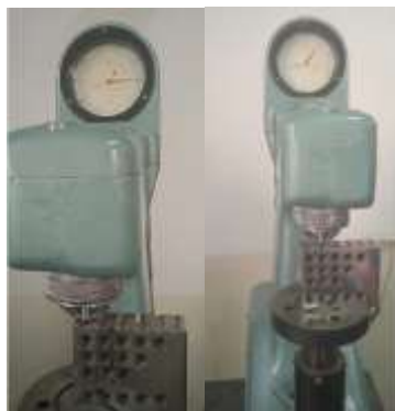
Рисунок 4 – Измерение твердости, поверхности, обработанной сверлением
