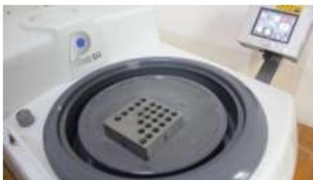
Рисунок 3 - Полировочная установка « PRESI Mintech 233»
