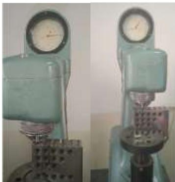
Рисунок 6 – Измерение твердости, поверхности, обработанной сверлением
