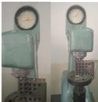
4 – Сүрөт. Көзөлгөн көзөнөктөрдүн бет катуулугун өлчөө
