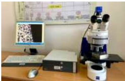
2 – Сүрөт. Микроскоп Axio Imager A1m/M1m
